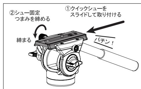
シュー固定つまみを緩めた状態で、①クイックシューを雲台の手前側から位置を合わせてまっすぐ差し込み、「パチン」と音がするまで確実に押し込みます。②取り付け後はシュー固定つまみをしっかりと締めて固定します。
