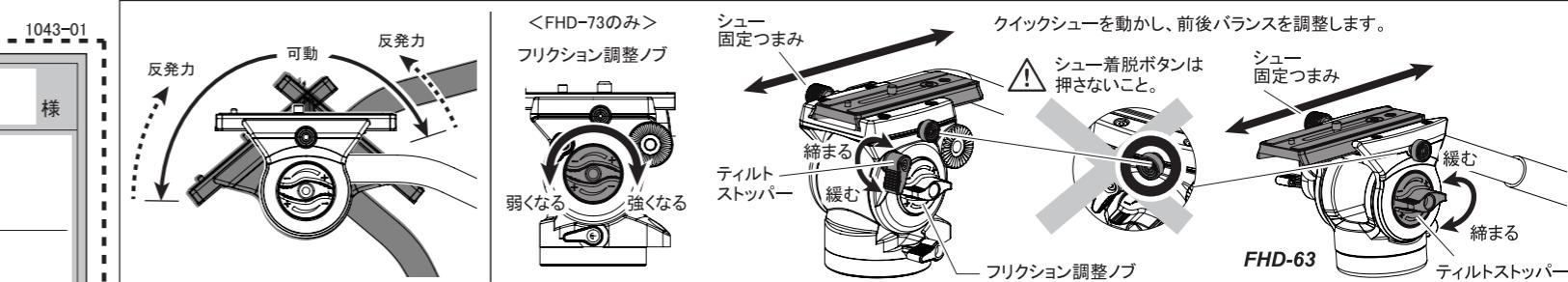
カメラ取付後、ティルトストッパーを緩めます。この時、カメラが前後に傾く場合は、シュー固定つまみを緩めてクイックシューを前後にスライドさせバランスを調整し、再度シュー固定つまみをしっかりと締めて固定します。できるだけ傾きが少くなる位置を探してください。調整後、ティルトストッパーを締め確実に固定してください。
