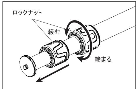
ロックナットを緩め、ポールを必要な長さまで伸ばしたら、ロックナットを締めて固定します。ポールを縮むときは逆の手順をおこなってください。
