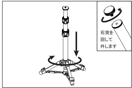
本製品は石突を回して外すことで、三脚に取り付けて延長棒などとして使うことができます。上図の矢印方向に本製品全体を回すか、三脚の雲台に取り付ける場合はカメラネジでしっかりと固定してください。
