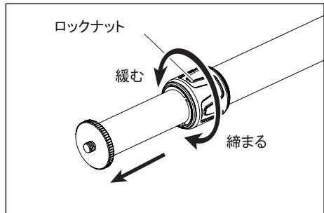
ロックナットを緩め、ポールを必要な長さまで伸ばしたら、ロックナットを締めて固定します。ポールを縮めるときは逆の手順をおこなってください。
