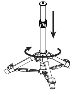
本製品は台座に取り付けネジ穴があるので、三脚に取り付けて延長棒などとして使うことができます。上図の矢印方向に本製品全体を回すか、三脚の雲台に取り付ける場合はカメラネジでしっかりと固定してください。
