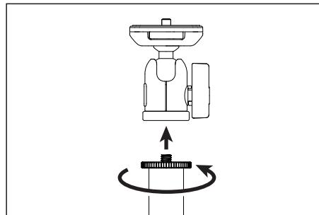
雲台を取り付ける場合は雲台の各ツマミネジをしっかりと締めてから雲台底面のネジ穴とカメラネジを確実に合わせ、延長ポール全体を上図矢印方向に回して取り付けます。
