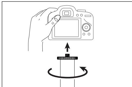
カメラ底面のネジ穴とカメラネジを確実に合わせ、延長ポール全体を上図矢印方向に回してしっかりと取り付けます。
