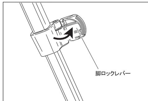
脚の伸縮は脚ロックレバーを起して脚を引き出し、必要な長さで脚ロックレバーを倒して固定します。脚を全段引き伸ばさないで使用する場合はできるだけ太い脚を使って撮影してください。
