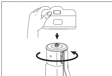
カメラ底面の取付ネジ穴に一脚のカメラネジを合わせ、一脚全体を矢印方向に回してしっかりと固定します。
