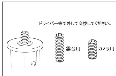
本製品には、カメラネジが長短2種類あります。使用状況により、適切なネジをお使いください。
