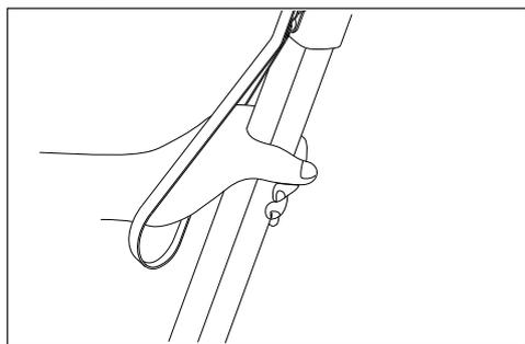
転倒事故防止・安定保持のため、必ず上図のようにハンドストラップを手首に通してカメラを支えてください。
