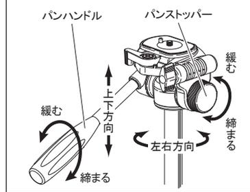
パンハンドルを反時計方向に回し緩めると、カメラを上下方向に向けることができます。パンストッパーを緩めると、カメラを左右方向へ向けることができます。
