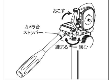
カメラ台ストッパーを緩めると、カメラを縦位置にすることができます。構図が決まった位置で各ハンドル・ストッパーを確実に締めて固定し、撮影してください。
