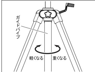
ガイドパイプを上図矢印方向に回すと、エレベーターの昇降動作を調節できます。
