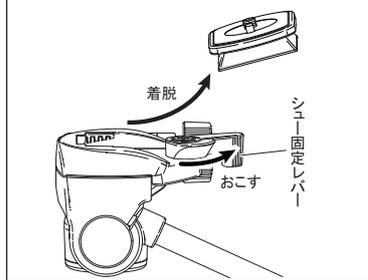
シュー固定レバーを最後までおこすと、クイックシューの着脱が可能です。カメラ底部にクイックシューを取り付け、三脚にクイックシューごとセットし、シュー固定レバーをしっかり押し込みます。
