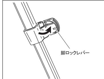
脚の伸縮は、脚ロックレバーを起して脚を引き出し、必要な長さで脚ロックレバーを倒して固定します。脚を全段引き伸ばさずに使用する場合は、できるだけ太い脚を使って撮影してください。
