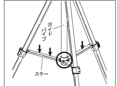
開脚時は、中央のステア付け根がガイドパイプの下端に届くまで、確実に開けてください。下端に届いていない場合は、ステアを上から手で押し下げて届かせてください。
