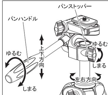
パンハンドル(ティルトストッパー)を反時計方向に回しゆるめると、カメラの上下方向が変更されます。パンストッパーをゆるめると、カメラを左右方向へ回転させることができます。
