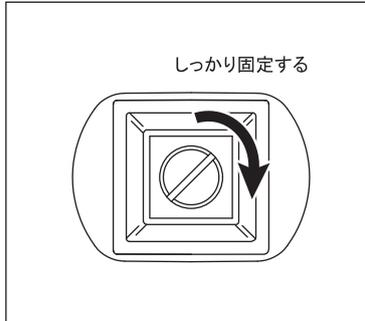
カメラ底部の取付ネジ穴に、クイックシューをドライバー等でしっかりと取り付け、三脚にクイックシューごとセットしてください。
