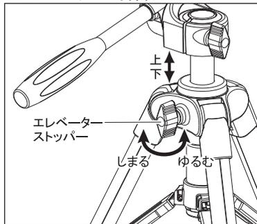
エレベーターストッパーをゆるめ、手動で高さを調整してください。必要な位置でエレベーターストッパーをしめて固定します。
