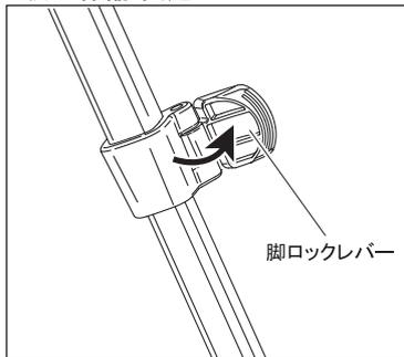
脚の伸縮は、脚ロックレバーを起こして脚を引出し、必要な長さで脚ロックレバーを倒して固定します。脚を全段引伸ばさないで使用する場合はできるだけ太い脚を使って撮影してください。
