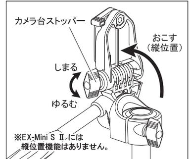
カメラ台ストッパーをゆるめると、カメラの傾きが変更されます。構図が決まった位置でハンドル棒とストッパーを確実にしめ、シャッターをきります。
