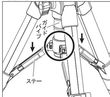
開脚時は、中央のステア付け根がガイドパイプの下端に届くまで、確実に開いてください。下端に届いていない場合は、ステアを上から手で押し下げて、届かせてください。
