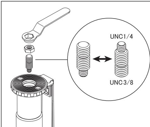
カメラネジ(雲台取付ネジ)は、UNC1/4(細ネジ)と3/8(太ネジ)の両サイズに対応します。サイズ変更するには、付属の工具で台座の六角ナットを外し、カメラネジを上図のように逆さにしてねじ込みます。その後、六角ナットを元通りに締め込んでください。
