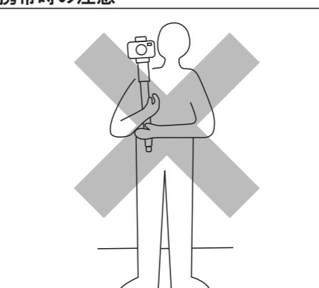
撮影場所の移動等の際は、必ず一脚からカメラを外して携帯してください。予想以上の力が加わった場合、カメラが落下する恐れがあります。特にカメラを装着したまま一脚を肩に担いで移動すると、カメラが視界に入らないので大変危険です。移動時は必ずカメラを外してください。
