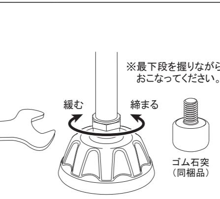
石突の交換は脚の最下段をしっかりと握りながら、付属の工具で蹄型石突の六角部分を上図矢印方向に回し、おこなってください(同梱のゴム石突は、手で回して取り付け・取り外しをしてください)。
