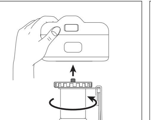
カメラ底面のネジ穴とカメラネジを確実に合わせ、一脚全体を上図矢印方向へ回してしっかりと取り付けます。
