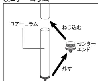
分割したエレベーター下部を、ローアコラムと呼びます。先端に付いているセンターエンドを回して外し、分割部分にねじ込んで「フタ」にすることができます。
