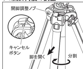
脚を閉じた状態で、開脚調整ノブをカチッと止まる位置まで右にスライドさせ、脚をいっばいに開くとフル開脚となります。エレベーターは固定した状態で下部を回すと分割できます。
