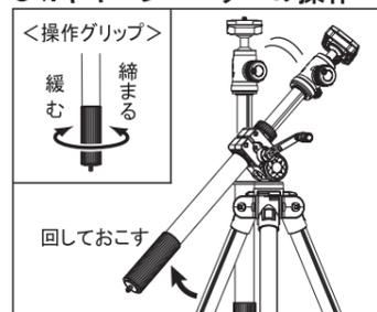
ギヤエレベーター下部の「操作グリップ」を上図緩む方向に回して起こします。ギヤエレベーターの伸びる方向を決めたら、締まる方向に回してしっかりと固定します。
