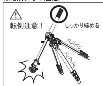
ギヤエレベーターを水平に近い角度で使用する場合や伸ばしている場合は、負荷が大きくなり中央部が緩みやすくなります。必ず操作グリップをしっかりと回して、確実に固定してください。また必ず各ストッパーが締まっていることを確認し、三脚を押さえながら慎重に操作してください。
