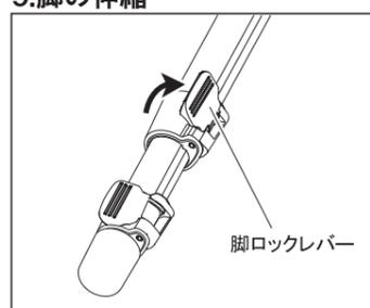
脚の伸縮は脚ロックレバーを起こして脚を引き出し、必要な長さまで脚ロックレバーを倒して固定します。脚を全段引き伸ばさないで使用する場合は、できるだけ太い脚を使って撮影してください。
