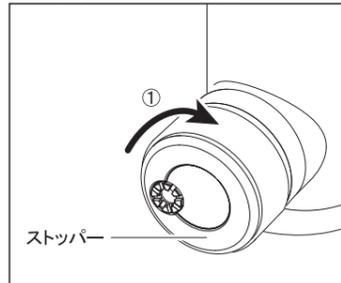
使用する機材に合わせ、ボールの作動力を調整することができます。まずストッパーを緩めから、下記の手順で行ってください。
