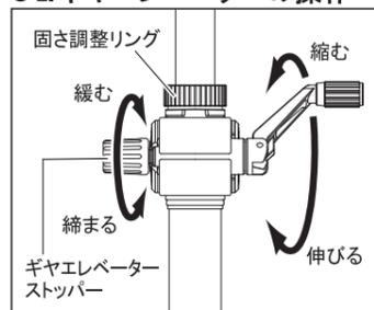
ギヤエレベーターストッパーを緩めクランクハンドルを回すと、ギヤエレベーターを伸ばすことができます。必要な位置でストッパーを締めて固定してください。
