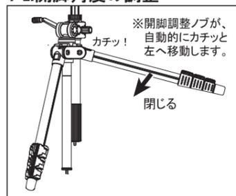
フル開脚(上図イラスト)にした脚をゆっくり閉じていくと、開脚調整ノブが自動的にカチッと左方向へスライドします。この位置がセミ開脚になります。
