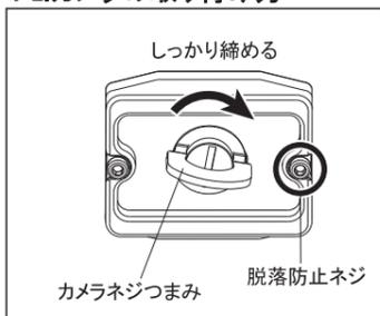
クイックシュー裏面のカメラネジつまみを起こして回し、しっかりとカメラに取り付けます。
