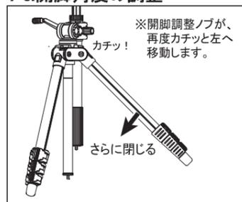
さらに脚を閉じていくと、再び開脚調整ノブが自動的にカチッとスライドし、標準開脚に戻ります。開脚角度は各々の脚で設定することが可能ですので、不整地などで三脚を使う場合にも有効です。
