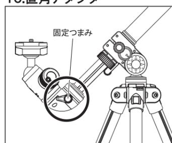
ギヤエレベーターを斜め下に向けた際、カメラを水平位置で構えたい場合は、同梱の直角アダプターを使います。雲台を外し、雲台とギヤエレベーターの間に直角アダプターを取り付けます。直角アダプターは固定つまみを緩めると水平回転しますので、雲台操作と合わせてカメラの向きを調整してください(固定つまみは「締め止まり位置の変更」が可能です。締めやすい位置でお使いください)。
