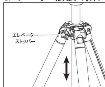
エレベーターストッパーを回して緩めると、エレベーターの昇降ができます。必要な位置でストッパーを締めて固定します。
