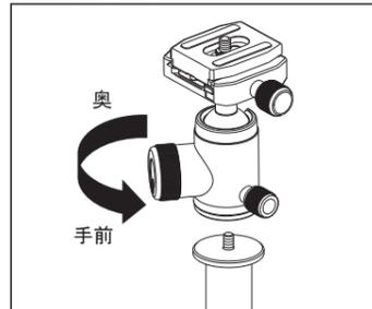
雲台を交換する場合は、各ストッパー類および三脚のエレベーターストッパーを確実に締め、雲台全体を反時計方向に回して外してください。他の別売雲台に交換可能です。
