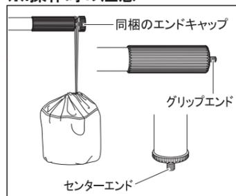
使用時はカメラ側が重くなり転倒する恐れがありますので、グリップエンドに同梱のエンドキャップを取り付けて重しとなるものを吊り下げたり、グリップエンドやセンターエンドに別売フックを取り付け、重しを引っ掛けるなどして安定させてください。
