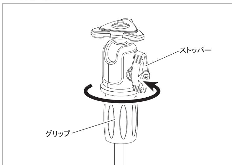
雲台を交換する場合は、ストッパーをしっかりと締め、グリップを持ち雲台全体を反時計方向に回して外して下さい。
