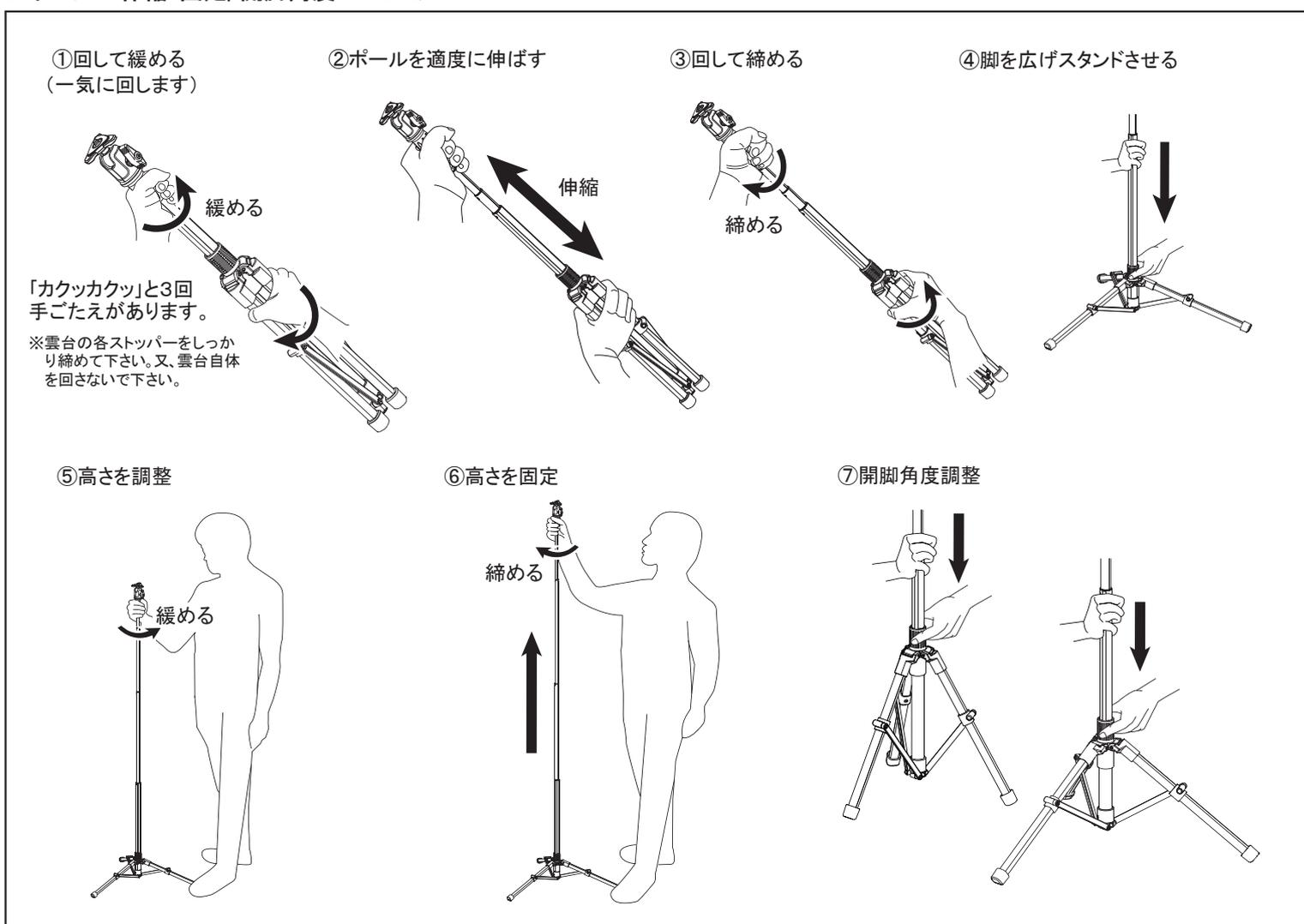
①脚全体を持ち、もう一方の手で雲台下のグリップを握り、緩む方向に「カクッカクッ」と3回の抵抗があるまで一気に回します。②ポールを適度に伸ばしたら、③グリップを締める方向にキツめに回し、ポールを固定します。縮めるときは逆の手順をおこなって下さい。④操作グリップを指で持ち、脚を開脚させ立たせます。⑤高さ調整はゴム石突を軽く足で踏んで固定し、グリップ部分を持って緩めご希望の高さに調整し、⑥締める方向に回し固定します。⑦開脚角度は自由にとめることができますので、操作グリップを上下させ使いやすい位置に調整してください。
