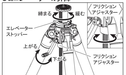
エレベータースッパーを締め、クランクハンドルを回すと、エレベーターの昇降ができます。このとき、フリクションアジャスターを回すと昇降の固さが調整できます(ゆるめ過ぎに注意してください)。必要な高さでエレベータースッパーを締めて固定してください。
