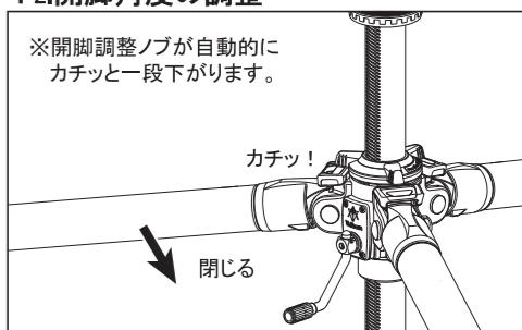
フル開脚(上図イラスト)にした脚をゆっくりと閉じていくと、開脚調整ノブが自動的にカチッと一段下がります。この位置がセミ開脚となります。
