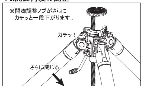
脚を閉じた状態で、開脚調整ノブをカチッと止まる位置まで上に引き上げ、脚を一杯に開くとフル開脚となります(フル開脚ではエレベーターを上げてください)。本製品のフル開脚は、不整地での調整用となります。
