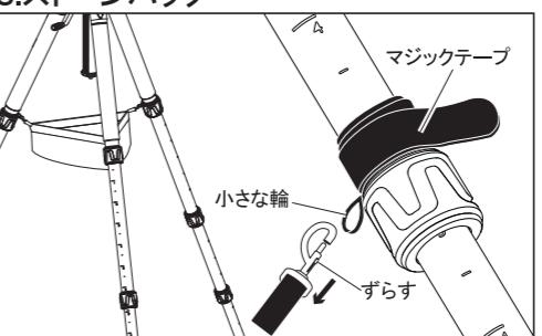
風の強い場所では、重し入れとしてストーンバッグをお使いください。バンドの小さな輪ができる方を内側にして、3本の脚それぞれにマジックテープできつく巻きつけます(上図)。その輪にストーンバッグのフックを引っかけて使用します。
