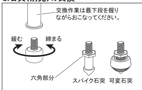
石突を交換するには、初期仕様のゴム石突を手で回して外し、別売石突付属の工具で六角部分を締まる方向に回して取り付けてください。
