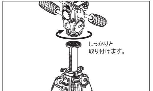
雲台(別売)を取り付けるには、雲台のハンドル棒や各ストッパー類、及び三脚のエレベータースッパーをしっかりと締め、雲台底面の取付ネジ穴と三脚側の雲台取付ネジを確実に合わせて、雲台全体を上図矢印方向にゆっくりと回してしっかりと固定します。
