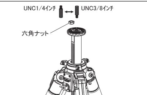
海外メーカー製の雲台には、取付ネジ穴のサイズがUNC3/8インチ(太ネジ)の機種があります。その場合は、三脚の雲台取付ネジを変換してください。付属の工具で台座の六角ナットを外し、雲台取付ネジを上下逆さにしてねじ込みます。その後、六角ナットを元通りに締め込んでください。
