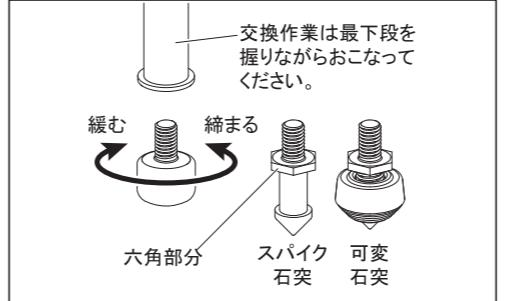
石突を交換するには、初期仕様のゴム石突を手で回して外し、別売石突付属の工具で六角部分を締まる方向に回して取り付けてください。
