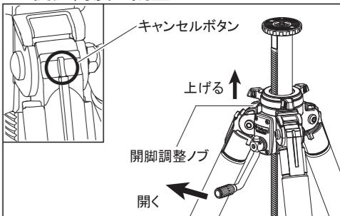
脚を閉じた状態で、開脚調整ノブをカチッと止まる位置まで上に引き上げ、脚一杯に開くとフル開脚となります(フル開脚ではエレベーターを上げてください。本製品のフル開脚は、不整地での調整用となります)。なお、誤ってノブを引き上げてしまった場合は、キャンセルボタンにより元の位置に戻すことができます。
