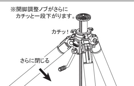
さらに脚を閉じていくと、再び開脚調整ノブが自動的にカチッと一段下がります。なお、開脚角度は各々の脚で自由に設定することができます。
