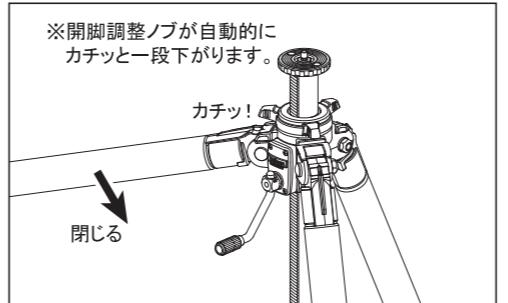
フル開脚(上図イラスト)にした脚をゆっくりと閉じていくと、開脚調整ノブが自動的にカチッと一段下がります。この位置がセミ開脚となります。
