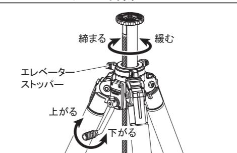
エレベータースッパーを緩め、クランクハンドルを回すと、エレベーターの昇降ができます。必要な高さでエレベータースッパーを締めて固定してください。
