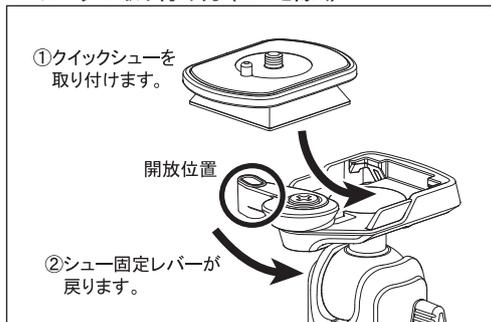
シュー固定レバーを最後まで起こした状態で、クイックシューをレバー側から斜めに滑らせるように取り付け、手動でレバーをしっかりと押し込んで下さい。
