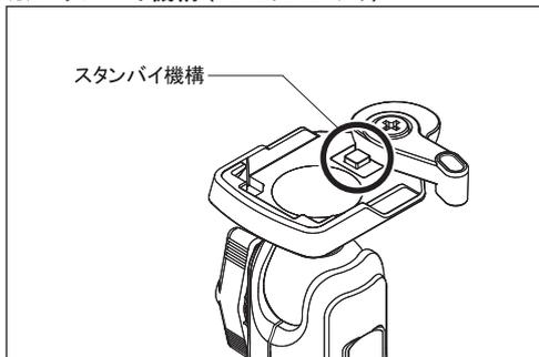
B61D/51Dには、レバーが開放位置で止まる「スタンバイ機構」があります。カメラ装着時にクイックシューごと下に押し付けるとスタンバイが解除され、レバーが途中で締まりますので、後は手動でしっかりとレバーを締め込んで下さい。
