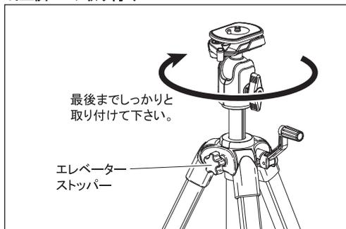
三脚への取り付けは、雲台のストッパー類、及び三脚のエレベーターストッパーを確実に締めてからおこなってください。三脚の雲台取付ネジと雲台底面の取付ネジ穴を合わせ、雲台全体を時計方向にゆっくり回し、しっかりと固定します。
