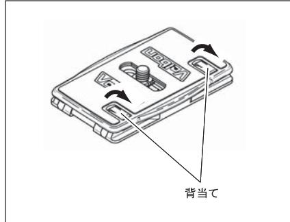
背当てをおこすと、カメラ縦位置時のレンズ重さによる前倒れを防ぐことができます。背当てはカメラネジ位置を移動させて、カメラの背面にうまく合わせてください。
