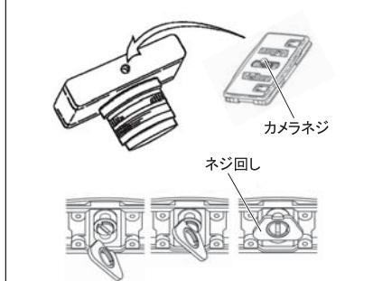
クイックシューのカメラネジと、カメラ底面のネジ穴を確実に合わせ、クイックシュー裏面に付いているネジ回しでしっかりとしめ付けます(ネジ回しを無くしてしまった場合は、コイン等で代用して下さい)。
