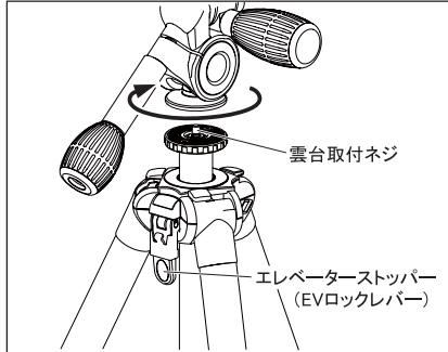
三脚への取り付けは、各ハンドル棒や三脚のエレベーターストップバーを確実にしめてからおこなってください。三脚の雲台取付ネジと、雲台底面の取付ネジ穴を確実に合わせ、雲台全体を時計方向にゆっくりと回し、しっかり固定します。
