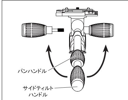
パンハンドル後ろに結合しているサイドティルトハンドルを回してはずし、雲台側面の穴に時計方向へねじ込み取り付けます。左右どちらにも取り付け可能です。三脚をケースに収納する際は、はずして元のようにパンハンドル後ろにねじ込んでください。
