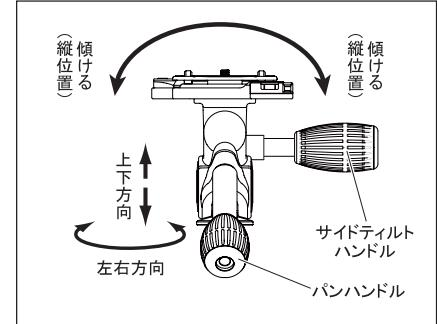
パンハンドルを反時計方向に回しゆるめると、カメラの上下方向と左右方向を同時に変えられます。サイドティルトハンドルをゆるめると、カメラの傾きがえられます。フレームが決まった位置で各ハンドルを確実にしめシャッターをきります。
