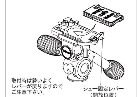
シュー固定レバーを開放位置にした状態で、クイックシューをレバー側から斜めに滑らせるように取り付け、下に押し付けるとレバーが戻り半自動固定されます。後は手動でレバーを最後まで押し込み確実に固定してください。
