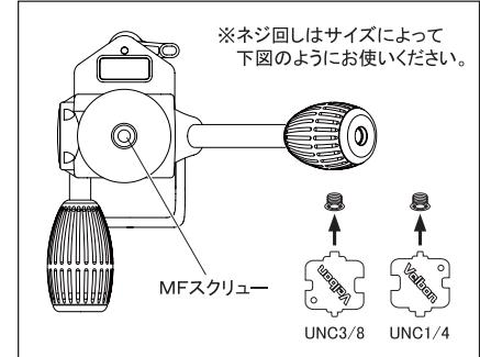
雲台の三脚取付ネジ穴は、ご購入時はUNC1/4インチ用となっています。UNC3/8インチの三脚に取り付ける場合は、付属のネジ回しでMFスクリューを交換してください。
