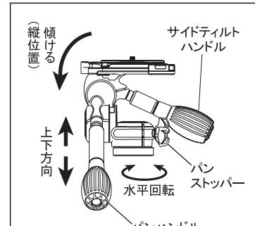
パンハンドルを反時計方向に回し緩めるとカメラの上下方向が変えられます。サイドティルトハンドルを回し緩めると、カメラを縦位置にすることができます。パンストッパーを回し緩めると、カメラを水平回転することができます。構図が決まった位置で各ストッパーを締め、シャッターをきります。
