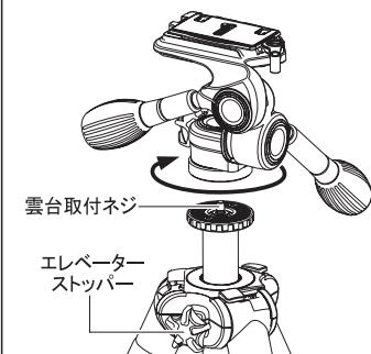
三脚への取り付けは、雲台のストッパー類及び三脚のエレベーターストッパーを確実に締めてからおこなって下さい。三脚の雲台取付ネジと雲台底面の取付ネジ穴を合わせ、雲台全体を時計方向にゆっくり回し、しっかりと固定します。
