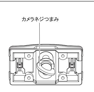
カメラ底面のネジ穴と、クイックシューのカメラネジを確実に合わせ、クイックシュー裏面のカメラネジつまみを起こして回し、しっかりと確実に取り付けて下さい。
