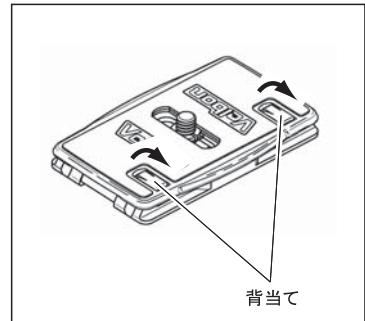
背当てをおこすと、カメラ縦位置時のレンズ重さによる前倒れを防ぐことができます。背当てはカメラネジの位置を移動させ、カメラ背面にうまく合わせて下さい。
