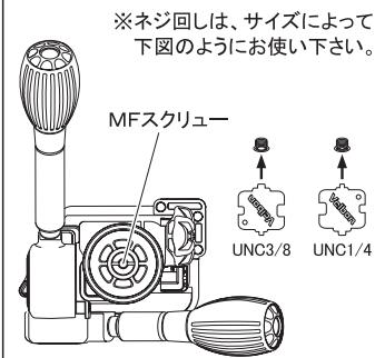
三脚取付ネジ穴は、ご購入時はUNC1/4インチ(細ネジ)用となっていますが、同梱の変換アダプターによりUNC3/8インチ(太ネジ)の三脚に取付けることが可能です。付属のネジ回しやコイン等でアダプターを交換して下さい。
