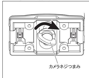
カメラ底面のネジ穴と、クイックシューのカメラネジを確実に合わせ、クイックシュー裏面のカメラネジつまみを起こして回し、しっかりと確実に取り付けてください。
