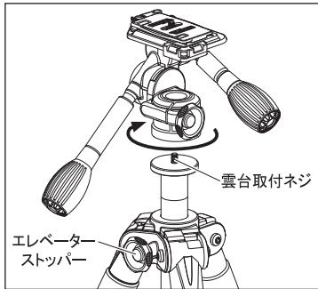
三脚への取り付けは、雲台のストッパー類及び三脚のエレベーターストッパーを確実に締めてからおこなってください。三脚の雲台取付ネジと雲台底面の取付ネジ穴を合わせ、雲台全体を時計方向にゆっくり回し、しっかりと固定します。
