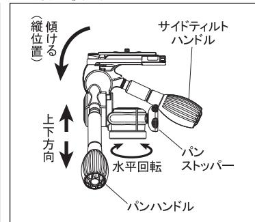
パンハンドルを反時計方向に回し緩めるとカメラの上下方向が変えられます。サイドティルトハンドルを回し緩めると、カメラを縦位置にすることができます。パンストッパーを回し緩めると、カメラを水平回転することができます。構図が決まった位置で各ストッパーを締め、シャッターワークをします。
