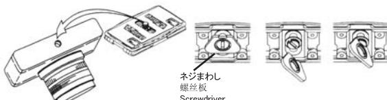
カメラのネジ穴とクイックシューのカメラネジを合わせて、シュー裏面に取り付けられているネジまわしを利用して、しっかりと固定して下さい。
