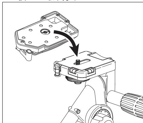
ベース裏面の三脚取付ネジ穴と三脚のネジを合わせ、
