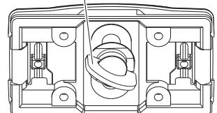
カメラ底面のネジ穴と、クイックシューのカメラネジを確実に合わせ、クイックシュー裏側のカメラネジつまみを起こして回し、しっかりと確実に取り付けて下さい。
