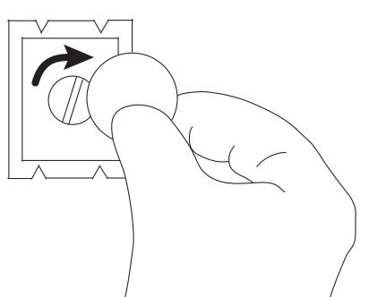
カメラ底面のネジ穴と、クイックシューのカメラネジを確実に合わせ、クイックシュー裏側からコインなどで上図矢印方向へ回し、しっかりと確実に取り付けて下さい。
