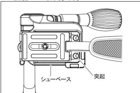
また、クイックシューとして取り付ける際は、上図のように、雲台のシューベース横にある2箇所突起の間に下部ベルトがくるようにして、取り付けして下さい。
