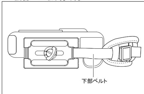
本製品は、互換性のある三脚の雲台へ、クイックシューとして取り付けることができます。取り付けの際は、下部ベルトがまっすぐ真横に伸びるようにして下さい。
