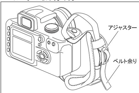
上部ベルトの先端をカメラの吊り金具に通し、さらにアジャスターを通して、カメラにしっかりと取り付けます。
