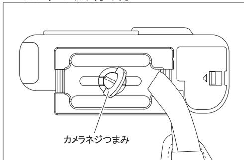
カメラ底面のネジ穴と本製品のカメラネジを慎重に合わせ、カメラネジつまみを起こして回し、しっかりと締め込みます。カメラネジは左右に動かすことができますので、必要に応じて調整して下さい。またコイン等で締め付けることも可能です。
