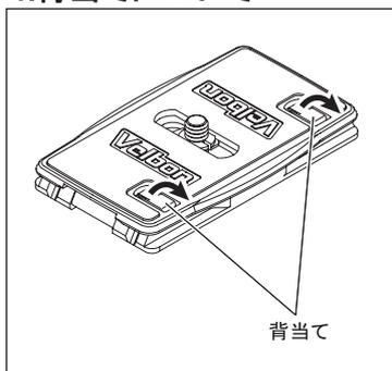
背当てをおおすと、カメラ縦位置時のレンズ重さによる前倒れを防ぐことができます。背当てはカメラネジ位置を移動させて、カメラの背面にうまく合わせてください。
