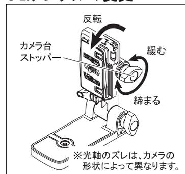
カメラ台ストッパーを上図矢印方向に緩め、カメラ台を内側に反転させ、カメラを縦位置にします。その後、カメラ台ストッパーを再度しっかりと締めます。
