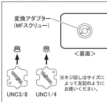
本製品の三脚取付ネジ穴は、ご購入時はUNC1/4インチ(細ネジ)用となっております。同梱の変換アダプターにより、UNC3/8インチ(太ネジ)の三脚に取り付けることが可能です。付属のネジ回しやコイン等で、アダプターを交換して下さい。
