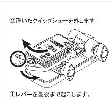
シュー固定レバーを最後まで起こすと、クイックシューが浮き上がりますので、上図矢印方向へスライドさせながら本体から外します。
