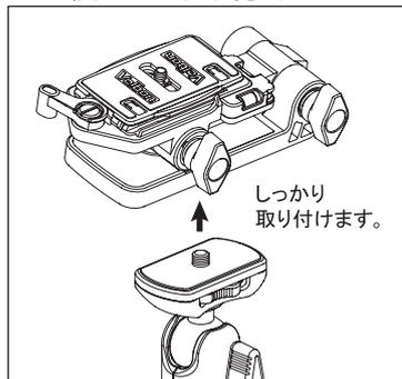
本製品裏面の三脚取付ネジ穴と、三脚(雲台)のカメラネジを合わせ、しっかり確実に取り付けして下さい。
