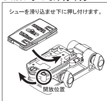
シュー固定レバーを開放位置にした状態でクイックシューをレバー側から斜めに滑らせるように取り付け、下に押し付けるとレバーが戻り半自動固定されます。後は手動でレバーをしっかり押し込んで下さい。
