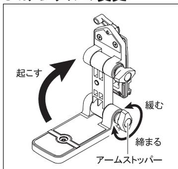
アームストッパーを上図矢印方向に緩め、カメラ台をアームごと起こします。その後、アームストッパーを再度しっかりと締めます。
