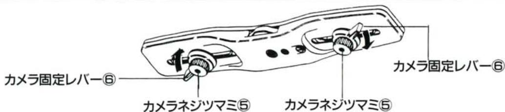
カメラのネジ穴とカメラネジ①を合わせてカメラネジツマミ⑤をしっかり回し、最後にカメラ固定レバー⑥を矢印方向にロックして固定して下さい。
