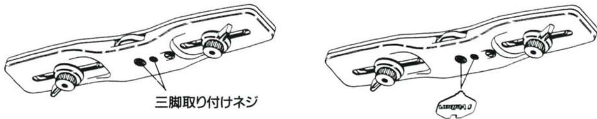
三脚側のネジを固定ダイヤル②の中心ネジに合わせてしっかり取り付けて下さい。太ネジの三脚に取り付ける場合はMFドライバーでMFスクリューを外して下さい。
