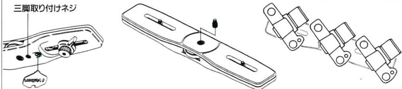
小型35ミリ一眼レフカメラは3台装着が可能です。まず、SPカメラスクリューを外し、固定ダイヤル上部のネジ穴に付け替え、固定ダイヤルを回してカメラを取り付けます。三脚は右側のネジ穴に取り付けて下さい。カメラは図のように各々斜めに取り付けます。
