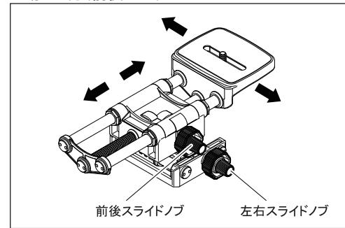
前後方向は「前後スライドノブ」を回して動かします。スライドノブ1回転で4mm可動し、精密なピント合わせが可能です。左右方向は「左右スライドノブ」を回して動かします。スライドノブ1回転で4mm可動し、微妙なフレーミングが可能です。
