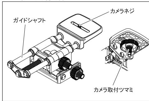
カメラ底面のネジ穴にカメラネジを合わせ、カメラ取付ツマミを回してしっかりと固定してください。
