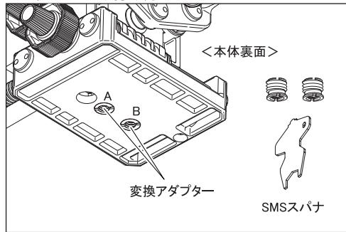
三脚への取り付けはA、Bどちらかのネジ穴を使用します。三脚のネジ位置により重心が中央にくるよう、バランスの良い方をお選びください。UNC3/8(太ネジ)の三脚に取り付ける場合は、付属のSMSスパナで変換アダプターをはずしてください。A、B両方のネジ穴に変換アダプターが入っています。
