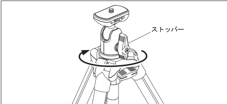
三脚への取り付けは、雲台のストッパー及び三脚のエレベーターストッパー等を確実にしておこなってください。三脚の雲台取付ネジと、雲台底面の取付ネジ穴を確実に合わせ、雲台全体を時計方向にしっかりと回し、しっかりと固定します。
