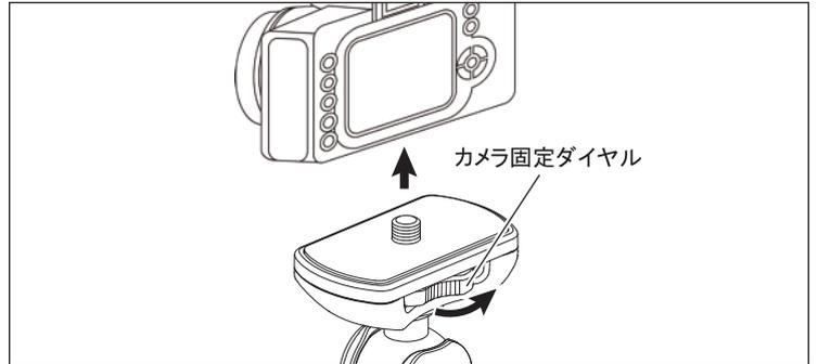
カメラ底面のネジ穴に雲台のカメラネジを合わせ、カメラ固定ダイヤルを上図矢印方向に回して、しっかりと取り付けます。
