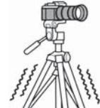
カメラを装着したまま脚の伸縮調整や雲台の操作をする際は、必ずカメラ本体を手で支えながらおこなってください。三脚やカメラが不意に動き、カメラを破損したり手を三脚にはさみケガをする恐れがあります。カメラやレンズの形状によってはバランスが取り難いこともありますので、十分に気をつけて下さい。
