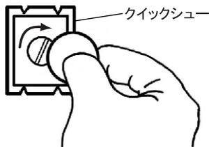
カメラのネジ穴にクイックシューのカメラネジを合わせ、裏側からコイン等で上図矢印方向へ回してしっかりと締め付けます。
