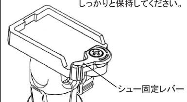
シュー固定レバーの操作は、カメラ落下防止のため必ずカメラを保持しながら行ってください。またシュー固定レバーが最後まで押し込まれ、クイックシューが確実に固定されている事を確認してください。
