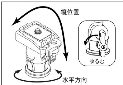
ストッパーをゆるめると、上図矢印の方向へカメラが自由に動きます。構図が決まった位置でストッパーをしめて固定し撮影します。
