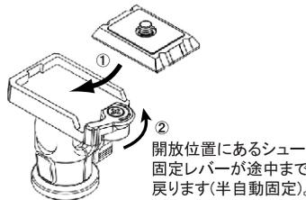
シュー固定レバーを開放位置にした状態でクイックシューをレバー側から斜めに滑らせるようにして取付け、下に押し付けると半自動固定されます。さらに指でレバーを最後まで押し込み、確実に固定してください。外すときは逆の手順を行ってください。
