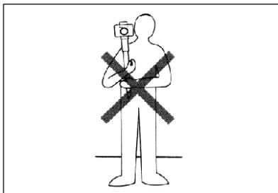
撮影場所の移動などの際は、必ず雲台からカメラを外して携帯してください。カメラを取付けたまま携帯すると予想以上の力が加わり、カメラが落下・破損する恐れがあります。
