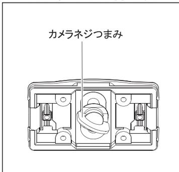
カメラ底面のネジ穴と、クイックシューのカメラネジを確実に合わせ、クイックシュー裏面のカメラネジつまみを起こして回し、しっかりと確実に取り付けして下さい。
