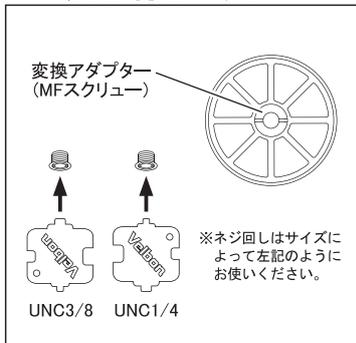
雲台の三脚取付ネジ穴は、ご購入時はUNC 1/4インチ(細ネジ)用となっておりますが、同梱の変換アダプターにより、UNC 3/8インチ(太ネジ)の三脚に取付けることが可能です。付属のネジ回しやコイン等でアダプターを交換して下さい。
