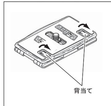
背当てをおこすと、カメラ縦位置時のレンズ重さによる前倒れを防ぐことができます。背当てはカメラネジ位置を移動させて、カメラの背面にうまく合わせてください。
