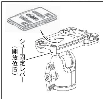
シュー固定レバーを開放位置にした状態で、クイックシューをレバー側から斜めに滑らせるように取り付け、下に押し付けるとレバーが戻り半自動固定されます。後は手動でレバーを最後まで押し込んでください。
