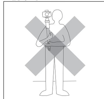
撮影場所の移動などの際は、必ず雲台からカメラを外して携帯して下さい。カメラを取り付けたまま携帯すると、予想以上の力が加わり、カメラが落下・破損する恐れがあります。
