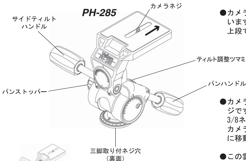
●カメラネジは二段構造になっています。下段をしめつけてから上段で増しジメします。
