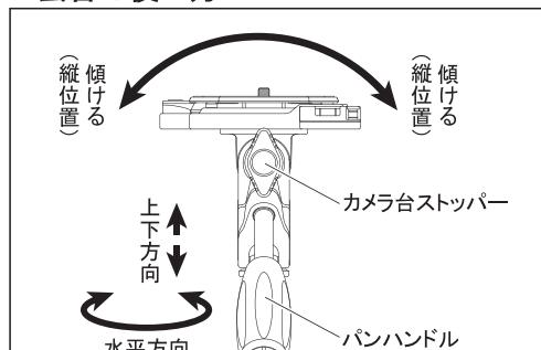
パンハンドルを反時計方向に回し緩めると、カメラの上下方向と水平方向が同時に変えられます。カメラ台ストップバーを緩めると、カメラの傾きが変えられます。構図が決まった位置でパンハンドルとカメラ台ストップバーを確実に締め、シャッターをきります。
