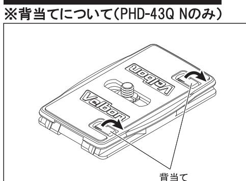
シュー固定レバーを「開放位置」にした状態で、クイックシューをレバー側から斜めに滑らせるようにして取り付け、下に押し付けるとレバーが戻り半自動固定されます。さらに指でレバーを押しこみ、確実に固定して下さい。
