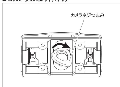
カメラ底面のネジ穴とクイックシューのカメラネジを確実に合わせ、クイックシュー裏面のカメラネジつまみを起こして回し、しっかりと確実に取り付けて下さい。
