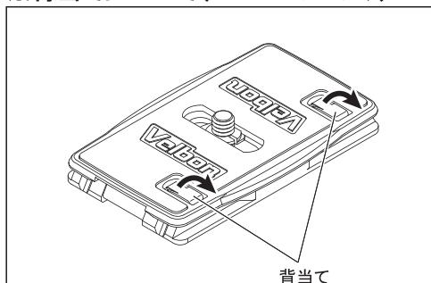
背当てをおこすと、カメラ縦位置時のレンズ重さによる前倒れを防ぐことができます。背当てはカメラネジ位置を移動させて、カメラの背面にうまく合わせて下さい。
