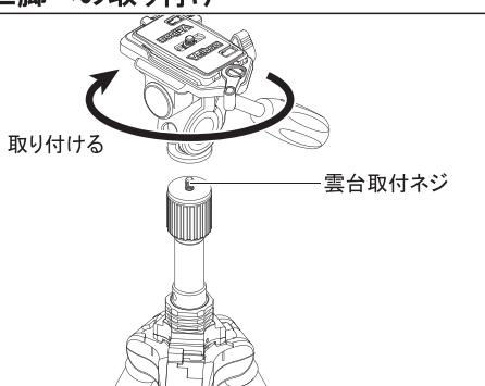
三脚への取り付けは、雲台のハンドル棒や各ストップバー類、及び三脚のエレベーターストッパーを確実に締めてからおこなって下さい。三脚の雲台取付ネジと雲台底面の取付ネジ穴を確実に合わせ、雲台全体を時計方向にゆっくり回し、しっかりと固定します。
