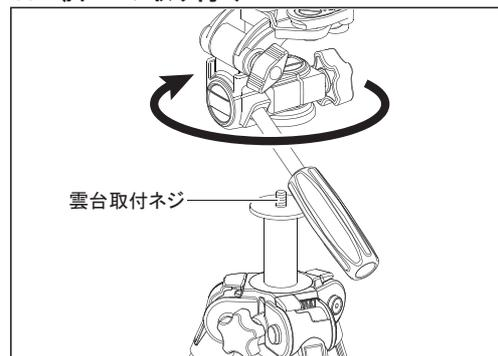
三脚への取り付けは、雲台のストップパー類及び三脚のエレベーターストップパーを確実に締めてからおこなってください。三脚の雲台取付ネジと雲台底面の取付ネジ穴を合わせ、雲台全体を上図矢印方向にゆっくりと回し、しっかり固定します。
