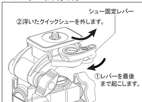
シュー固定レバーを最後まで起こすとクイックシューが浮き上がりますので、上図矢印方向へスライドさせながら本体から外します。
