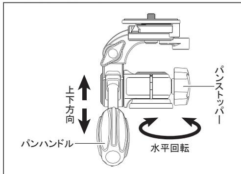
パンハンドルを反時計方向に回し緩めると、カメラの上下方向が変えられます。パンストップパーを回し緩めると、カメラを水平回転することができます。
