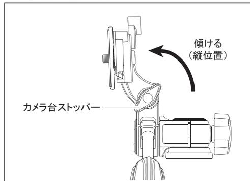
カメラ台ストップパーを回し緩めると、カメラを縦位置にすることができます。構図が決まった位置で各ストップパーを締め、シャッターをきります。
