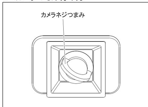
カメラ底面のネジ穴と、クイックシューのカメラネジを確実に合わせ、クイックシュー裏面のカメラネジつまみを起こして回し、しっかりと確実に取り付けして下さい。
