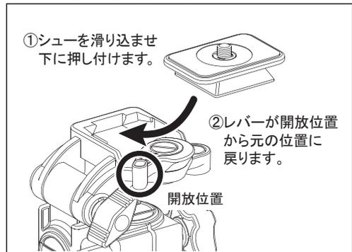
シュー固定レバーを「開放位置」にした状態で、クイックシューをレバー側から斜めに滑らせるように取り付け、下に押し付けるとレバーが戻り半自動固定されます。後は手でレバーをしっかり押し込んで下さい。
