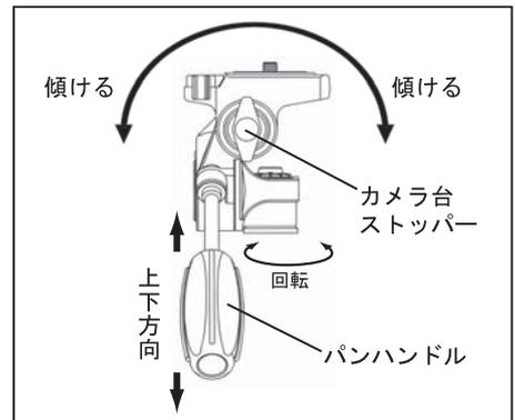
パンハンドルを回してゆるめるとカメラの上下方向が変更されると同時に、横方向へ回転させることができます。カメラ台ストッパーをゆるめると左右両方向へカメラを傾けることができます。必要な位置で固定してシャッターをきります。
