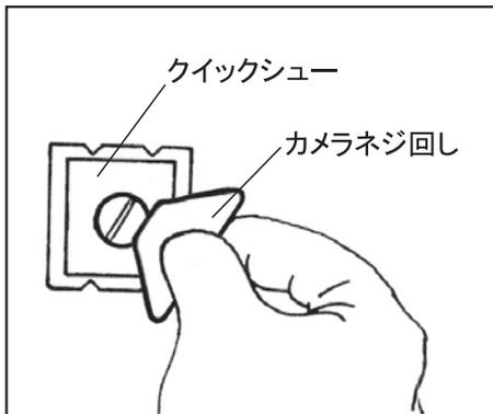
カメラのネジ穴とクイックシューのカメラネジを合わせ、付属のカメラネジ回しでしっかりと締めます。カメラネジ回しを無くしてしまった場合は、コイン等で代用してください。
