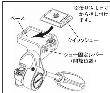
シュー固定レバーを開放位置にした状態で、クイックシューをレバー側から斜めに滑らせるように取り付け、下に押し付けると半自動固定されます。後は手でレバーをしっかりと締めてください。外すときは逆の手順を行ってください。
