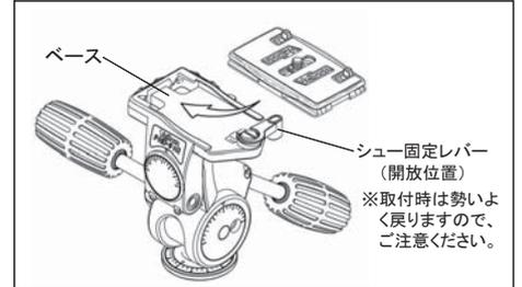
シュー固定レバーを開放位置にした状態で、クイックシューをレバー側から斜めに滑らせるように取り付け、下に押し付けるとレバーが戻り半自動固定されます。後は手動でレバーを最後まで押し込んでください。
