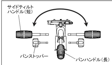
同梱されている各ハンドル棒を、雲台の各々の穴に時計方向へねじ込み取り付けます。サイドティルトハンドルとパンストッパーは逆側に取り付けることも可能です。※サイドティルトハンドルとパンストッパーは同じ側面に取り付けてください。それぞれ違う側面に取り付けると、カメラを縦位置にしながら上方に向けることはできません。
