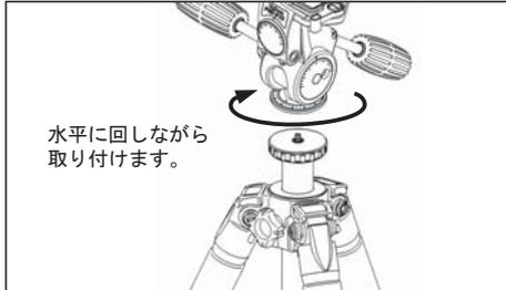
三脚への取り付けは、各ハンドル棒とストッパーを確実にしめてから行なってください。三脚取付ネジ穴を合わせて、雲台全体を上図矢印方向にゆっくりと回し、しっかりと固定します。
