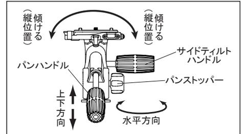
パンハンドルを反時計方向に回しゆるめると、カメラの上下方向が変わります。サイドティルトハンドルをゆるめると、カメラの傾きが変わります。パンストッパーをゆるめると、カメラを水平方向へ回転させることができます。フレームが決まった位置で各ハンドル棒とストッパーを確実にしめ、シャッターをきります。
