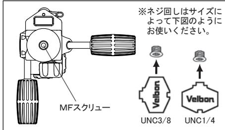
雲台の三脚取付ネジ穴は、ご購入時はUNC1/4インチ用となっております。UNC3/8インチの三脚に取り付ける場合は、付属のネジ回しでMFスクリューを交換してください。※MFスクリューはゆるみ止め処理(青色)がされています。交換時にゆるめるときは固まっています。
