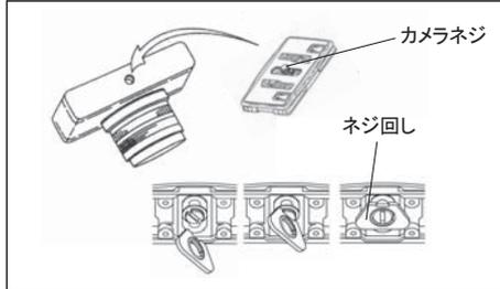
カメラのネジ穴とカメラネジを確実に合わせ、クイックシュー裏面に付いているネジ回しでしっかりと締め付けます（ネジ回しを無くしてしまった場合は、コイン等で代用してください）。
