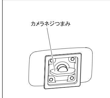
カメラ底面のネジ穴と、クイックシューのカメラネジを確実に合わせ、クイックシュー裏面のカメラネジつまみを起こして回し、しっかりと取り付けて下さい。
