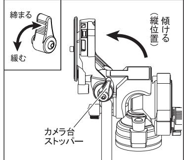
カメラ台ストップーを緩めると、カメラを縦位置にすることができます。構図が決まった位置で各ストップーを締め、撮影して下さい。
