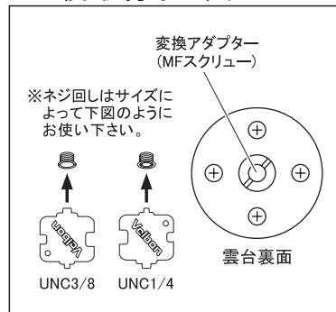
三脚取付ネジ穴は、ご購入時はUNC1/4インチ（細ネジ）用となっていますが、同梱の変換アダプターによりUNC3/8インチ（太ネジ）の三脚に取り付けることが可能です。付属のネジ回しやコイン等でアダプターを交換して下さい。
