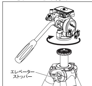
三脚への取り付けは、雲台のストッパー類及び三脚のエレベーターストッパーを確実に締めてからおこなって下さい。三脚の雲台取付ネジと雲台底面の取付ネジ穴を合わせ、雲台全体を時計方向に「へりくつり」／「かついで」固定します。
