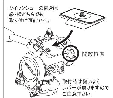
シュー固定レバーを開放位置にした状態で、クイックシューをレバー側から斜めに滑らせるように取付け、下に押し付けるとレバーが戻り半自動固定されます。後は手動で、レバーをしっかりと押込んで下さい。
