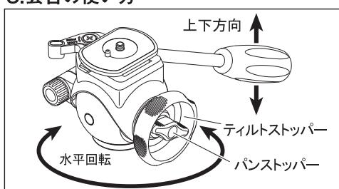
ティルトストッパーを回し緩めると、カメラの上下方向が変えられます。パンストッパーを回し緩めると、カメラを水平回転することができます。
