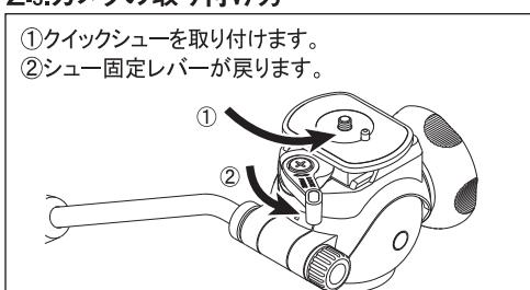
シューフィクシューを最後まで起こした状態で、クイックシューをレバー側から斜めに滑らせるように取り付け、下に押し付けるとレバーが戻ります(クイックシューは縦・横どちら向きでも取り付け可能です)。後は手動でレバーをしっかりと押し込んでください。
