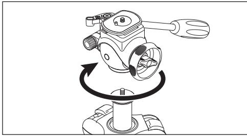
三脚への取り付けは、雲台のストッパー類及び三脚のエレベータースッパーを確実に締めてから、おこなってください。三脚の雲台取付ネジと、雲台底面の三脚取付ネジ穴を合わせ、雲台全体を時計方向にゆっくり回し、しっかりと固定します。
