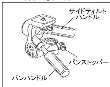
パンハンドルを反時計方向に回してゆるめると、カメラの上下方向が変えられます。サイドテイルハンドルをゆるめると、カメラを縦位置にできます。パンストッパーをゆるめると、カメラを水平に回転させることができます。フレームが決まった位置で各ストッパーを確実にしめ、シャッターをきります。
