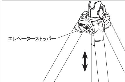
エレベータースッパーを回し緩めると、エレベーターの昇降ができます。必要な位置でスッパーを締めて固定します。
