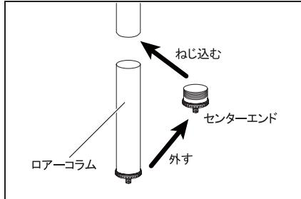
分割したエレベーター下部をロアーコラムと呼びます。先端に付いているセンターエンドを回して外し、分割部分にねじ込んで「フタ」にすることができます。
