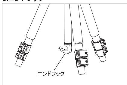
付属のエンドフックは、上図のようにセンターエンドに取り付けて使用します。カメラバッグ等を吊り下げ、安定性を確保します。吊り下げたバッグが風にあおられるとブレの原因になりますので、ベルトは出来るだけ短くして吊り下げて下さい。
