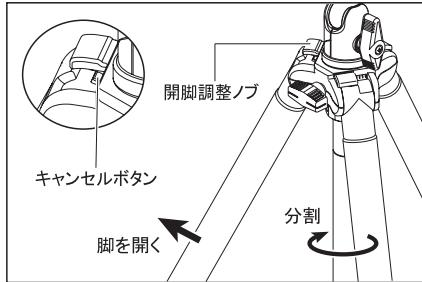
脚を開じた状態で、開脚調整ノブをカチッと止まる位置まで右にスライドさせ、脚をいっぱいに開くとローポジションとなります。エレベーターは固定した状態で下部を回すと分割できます。※誤ってノブをスライドさせてしまった場合は、キャンセルボタンを押して元の位置に戻すことができます。
