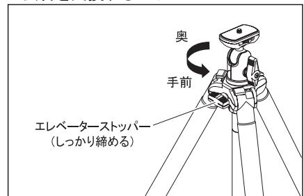
雲台を交換する場合は、雲台のスッパー及び三脚のエレベータースッパーをしっかりと締め、雲台全体を反時計方向に回して外して下さい。他の別売雲台に交換可能です。
