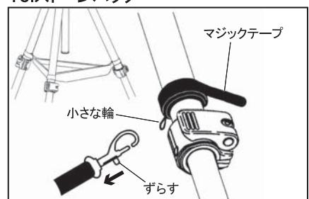
風の強い場所では、重し入れとしてストーンバッグをお使いください。バンドの小さな輪ができる方を内側にして、3本の脚それぞれに、マジックテープできつく巻きつけます(上図)。その輪にストーンバッグのフックを引っかけて使用します。
