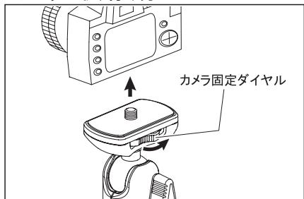
カメラ底面のネジ穴に雲台のカメラネジを合わせ、カメラ固定ダイヤルを上図矢印方向に回して、しっかりと取り付けます。
