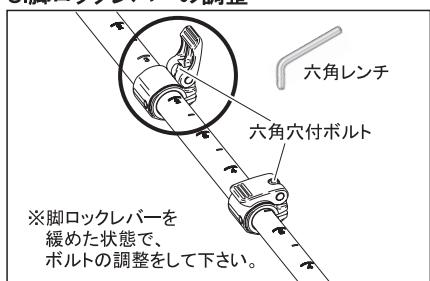
長期間の使用等で、脚ロックが緩くなった場合には、上図の六角穴付ボルトを付属の六角レンチで締めて調整します。六角穴付ボルトを締めすぎると、レバーの開閉が固くなりますのでご注意下さい。
