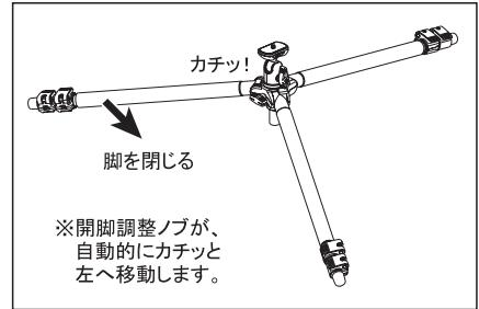
ローポジション(上図イラスト)にした脚をゆっくり閉じていくと、開脚調整ノブが自動的にカチッと左方向へスライドします。この位置がセミローポジションとなります。
