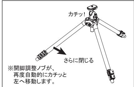
※開脚調整ノブが、再度自動的にカチッと左へ移動します。
