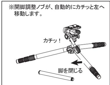
ローポジション (上図イラスト) にした脚をゆっくり閉じていくと、開脚調整ノブが自動的にカチッと左方向へスライドします。この位置がセミローポジションとなります。
