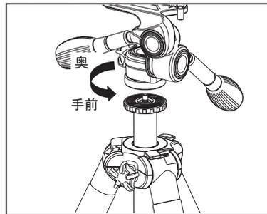
雲台を交換する場合は、各ハンドル棒とストップパー類及び三脚のエレベーターストップパーをしっかりと締め、雲台全体を反時計方向に回して外して下さい。自由雲台など他の別売雲台に交換可能です。
