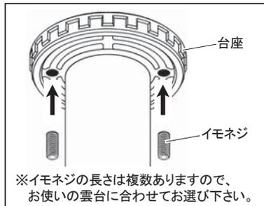
操作時に雲台が緩まないようにするための「雲台固定用イモネジ」が付属しています。台座下から同梱の六角レンチでねじ込み、雲台底面に突き当て下さい。
