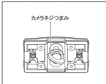
カメラ底面のネジ穴と、クイックシューのカメラネジを確実に合わせ、クイックシュー裏面のカメラネジつまみを起こして回し、しっかりと確実に取り付けして下さい。
