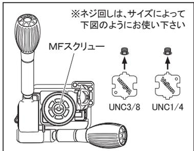
雲台の三脚取付ネジ穴はご購入時はUNC1/4インチ (細ネジ) 用となっています。UNC3/8インチ (太ネジ) の取付ネジを使う場合は、付属のネジ回しでMFスクリューを交換して下さい。※MFスクリューは緩み止め処理がされていますので固めになっています。
