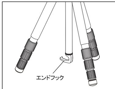
付属のエンドフックは、上図のようにセンターエンドに取り付けて使用します。カメラバッグ等を吊り下げ、安定性を確保します。吊り下げたバッグが風にあおられるとブレの原因になりますので、ベルトは出来るだけ短くして吊り下げ下さい。
