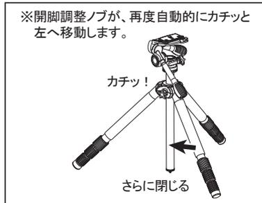
さらに脚を閉じていくと、再び開脚調整ノブが自動的にカチッとスライドし、標準開脚に戻ります。
