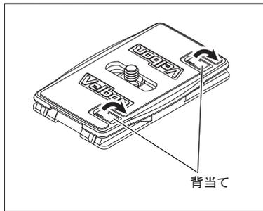
背当てをおおすと、縦位置撮影時のレンズ重さによる「前倒れ」を防ぐことができます。カメラネジの位置を調整してカメラの背面にうまく合わせて下さい。
