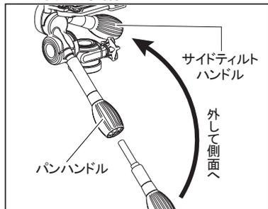
ご購入時はパンハンドルのグリップにサイドテイルハンドルがねじ込まれています。サイドテイルハンドルを回して外し、側面に取り付けてご使用下さい。三脚ケースに収納する際は、元のようにハンドルを結合して下さい。
