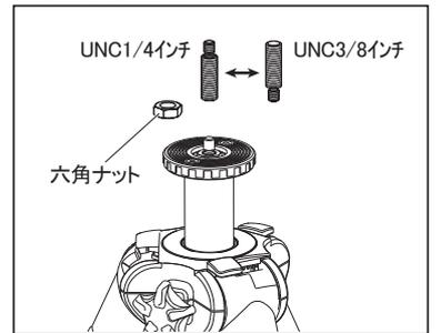
N600シリーズは雲台取付ネジのサイズを変換することができます。海外メーカー製の雲台を付ける場合は、UNC3/8 (太ネジ) にサイズ変換して下さい。付属の工具で台座の六角ナットを外し、雲台取付ネジを逆さにしてねじ込みます。その後、六角ナットを元通りに締めこみます。
