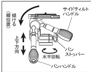
パンハンドルを反時計方向に回し緩めると、カメラの上下方向が変更されます。サイドティルトハンドルを回し緩めると、カメラを縦位置にすることができます。パンストップパーを回し緩めると、カメラを水平回転することができます。構図が決まった位置で各々ストップパーを締め、シャッターをきります。
