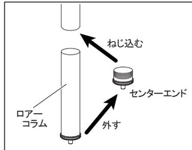
分割したエレベーター下部を、ローコラムと呼びます。先端に付いているセンターエンドを回して外し、分割部分にねじ込み「フタ」にすることができます。
