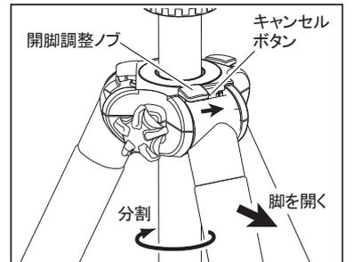
脚を閉じた状態で、開脚調整ノブをカチッと止まる位置まで右にスライドさせ、脚をいっぱい開くとローポジションとなります。エレベーターは固定した状態で下部を回すと、分割できます。※誤ってノブをスライドさせてしまった場合は、キャンセルボタンを押して元の位置に戻すことができます。
