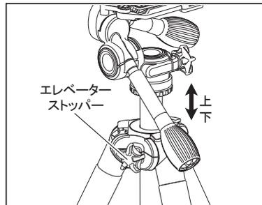
エレベーターストップパーを回して緩めると、エレベーターの昇降ができます。必要な位置でストップパーを締めて固定します。
