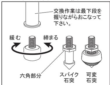
石突を交換するには、初期仕様のゴム石突を手で回して外し、別売石突付属の工具で六角部分を締まる方向に回して取り付けて下さい。
