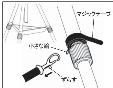
風の強い場所では、重し入れとしてストーンバッグをお使いください。バンドの小さな輪ができていて内側にして、3本の脚それぞれにマジックテープできつく巻きつけます (上図)。その輪にストーンバッグのフックを引っかけて使用します。
