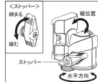
ストッパーをゆるめると、重さでカメラが急に倒れます。レンズをぶついたりして破損しないよう、十分注意して操作してください。
