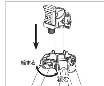
エレベーターストッパーを上図緩む方向に回し、エレベーターを使いやすい位置まで下げて調整してください。
