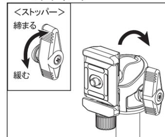
ストッパーを操作して雲台の台座を起し、使用位置にします。
