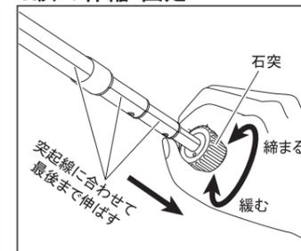
脚を伸ばすには、脚先端の石突を握り、緩む方向に「カクッカクッ」と段数の節目分の抵抗が止まるまで一気に回します。脚を最後まで引き伸ばしたら、石突を締まる方向にキツめに回し固定します。脚を締める際は、逆の手順をおこなってください。
