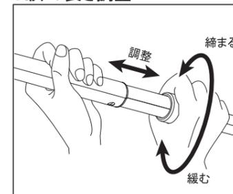
脚の長さを調整するには2段目の調整用グリップを握り、矢印の緩む方向に回してからおこないます。調整後は矢印の締まる方向へキツめに回し、脚を固定します。
