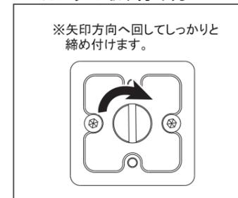
カメラ底面のネジ穴にクイックシューのカメラネジを合わせ、裏側からドライバー等で上図矢印方向へ回し、しっかりと確実に締め付けます。
