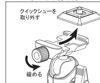
シュー固定つまみを上図矢印方向に回して十分に緩め、クイックシューを外します。
