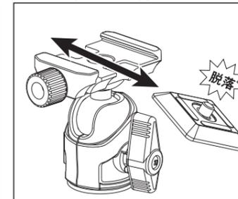
脱落防止ネジを外した状態では、シュー固定つまみを緩めると、カメラが自由に動かすことができます。アンクルが決まったらストッパーを滑して固定し、シャッターをきります。
