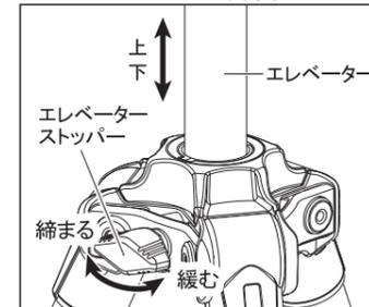
エレベーターストッパーを回し緩めると、エレベーターの昇降ができます。必要な位置でストッパーを締めて固定します。
