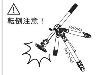
ギヤエレベーターの向きによってはバランスが悪くなり、三脚が転倒する恐れがありますので、必ず三脚を押さえながら慎重に操作して下さい。
