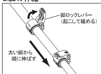
脚を伸ばす時は上の段から順に伸ばします。縮める時は下の段から順にしまって下さい。脚を最後まで伸ばさないで設置する場合は、できるだけ太い脚を使い、安定性を高めるようにします。
