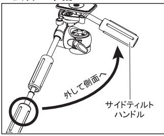
ご購入時はパンハンドルのグリップにサイドティルトハンドルがさし込まれています。サイドティルトハンドルを引きながら外し、側面に取り付けてご使用下さい。三脚ケースに収納する際は、元のようにハンドルを結合して下さい。
