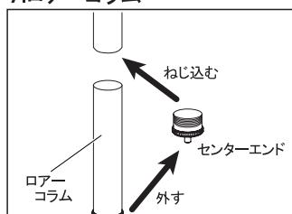
分割したエレベーター下部を、ロアーコラムと呼びます。先端に付いているセンターインドを回して外し、分割部分にねじ込んで「フタ」にすることができます。
