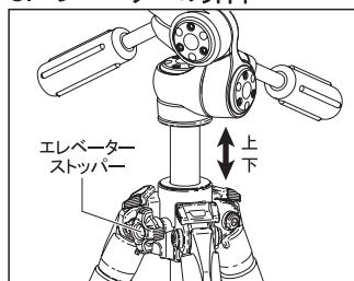
エレベーターストッパーを回して緩めると、エレベーターの昇降ができます。必要な位置でストッパーを締めて固定します。
