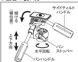
パンハンドルを反時計方向に回し緩めると、カメラの上下方向が変えられます。サイドティルトハンドルを回し緩めると、カメラを縦位置にすることができます。パンストッパーを回し緩めると、カメラを水平回転することができます。構図が決まった位置で各々ストッパーを締め、シャッターをきります。
