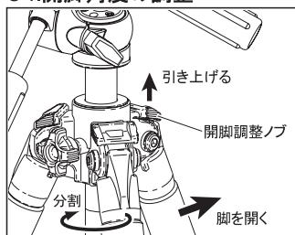
脚を閉じた状態で、開脚調整ノブをカチッと止まる位置まで上に引き上げ、脚をいっぱいに開くとロープポジションとなります。
