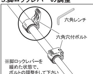
\*脚ロックレバーを緩めた状態で、ボルトの調整をして下さい
