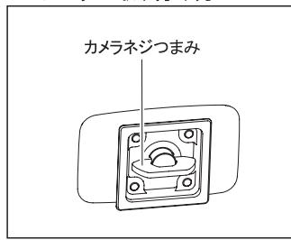
カメラ底面のネジ穴と、クイックシューのカメラネジを確実に合わせ、クイックシュー裏面のカメラネジつまみを起こして回し、しっかりと確実に取り付けて下さい。
