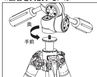
雲台を交換する場合は、各ハンドル棒とストッパー類及び三脚のエレベーターストッパーをしっかりと締め、雲台全体を反時計方向に回して外して下さい。自由雲台など他の別売雲台に交換可能です。
