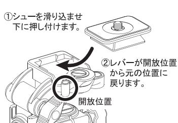
シューフィニッシュを「開放位置」にした状態で、クイックシューをレバー側から斜めに滑らせるように取り付け、下に押し付けるとレバーが戻り半自動固定されます。後は手動でレバーをしっかりと押し込んで下さい。
