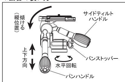
パンハンドルを反時計方向に回し緩めると、カメラの上下方向が変えられます。サイドティルトハンドルを回し緩めると、カメラを縦位置にすることができます。パンストップパーを回し緩めると、カメラを水平回転することができます。構図が決まった位置で各々のストップパーを締め、シャッターをきります。
