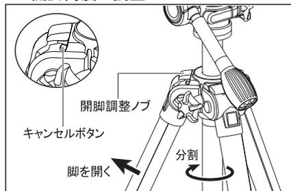
脚を閉じた状態で、開脚調整ノブをカチッと止まる位置まで右にスライドさせ、脚をいっぱい開くとローポジションとなります。エレベーターは固定した状態で下部を回すと分割できます。※誤ってノブをスライドさせてしまった場合は、キャンセルボタンを押して元の位置に戻すことができます。
