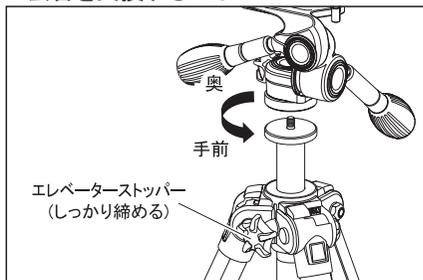
雲台を交換する場合は、各ハンドル棒とストップパー類、及び三脚のエレベーターストップパーをしっかり締め、雲台全体を反時計方向に回して外して下さい。自由雲台など他の別売雲台に交換可能です。
