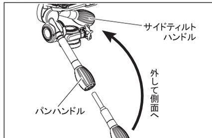
ご購入時は、パンハンドルのグリップにサイドテイルハンドルがねじ込まれています。サイドテイルハンドルを回して外し、側面に取り付けてご使用下さい。三脚ケースに収納する際は、元のようにハンドルを結合して下さい。
