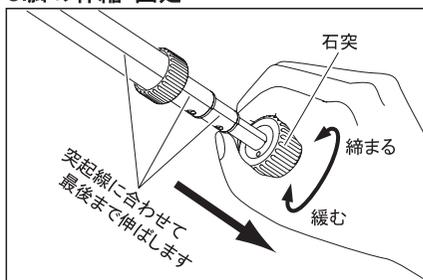
脚を伸ばすには、脚先端の石突を握り、緩む方向に「カクカク」と段数の節目分の抵抗が止まるまで一気に回します。脚を最後まで引き伸ばしたら、石突を締まる方向にキツめに回し固定します。脚を縮める際は逆の手順をおこなって下さい。
