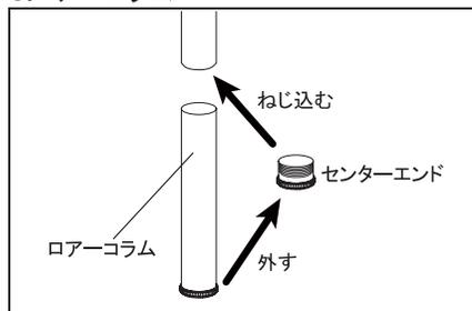
分割したエレベーター下部をローコラムと呼びます。先端に付いているセンターエンドを回して外し、分割部分にねじ込んで「フタ」にすることができます。
