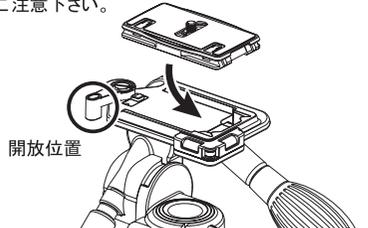
シュー固定レバーを開放位置にした状態で、クイックシューをレバー側から斜めに滑らせるように取り付け、下に押し付けるとレバーが戻り半自動固定されます。後は手動でレバーを確実に押し込んで下さい。
