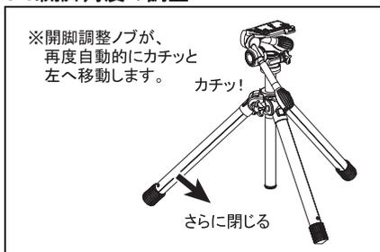
さらに脚を閉じていくと、再び開脚調整ノブが自動的にカチッとスライドし、標準開脚に戻ります。
