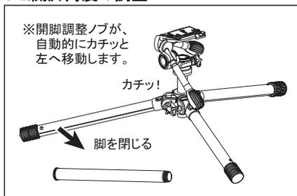
ローポジション(上図イラスト)にした脚をゆっくり閉じていくと、開脚調整ノブが自動的にカチッと左方向へスライドします。この位置がセミローポジションとなります。
