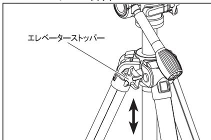
エレベーターストップパーを回し緩めると、エレベーターの昇降ができます。必要な位置でストップパーを締めて固定します。
