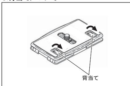
背当てをおおすと、縦位置撮影時のレンズ重さによる「前倒れ」を防ぐことができます。カメラネジの位置を調整して、カメラの背面にうまく合わせて下さい。
