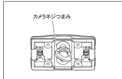
カメラ底面のネジ穴と、クイックシューのカメラネジを確実に合わせ、クイックシュー裏面のカメラネジつまみを起こして回し、しっかりと確実に取り付けして下さい。
