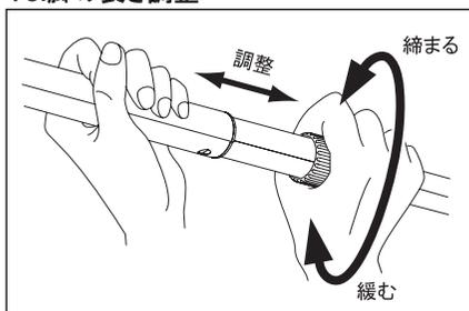
脚の長さを調整するには、二段目の調整用グリップを握り、緩む方向に回して伸縮し調整します。調整後は締まる方向へキツめに回し、脚を固定します。
