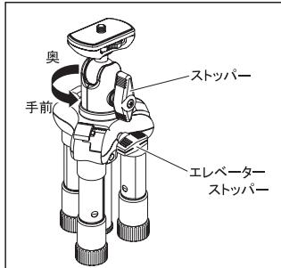
三脚から雲台を外すには、ストップバー及びエレベータースtopバーをしっかりと締め、雲台全体を左回し(上図矢印方向)に回すと外れます。他の雲台を取り付けることが可能です。
