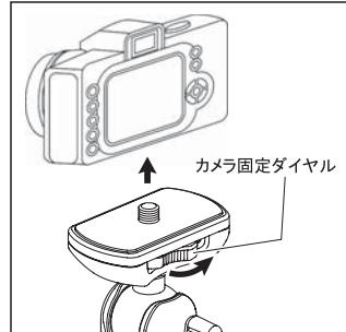
カメラ底面のネジ穴に、雲台のカメラネジを合わせ、カメラ固定ダイヤルを上図矢印方向に回して、しっかりと取り付けます。
