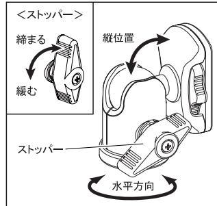
カメラをしっかりと保持しながらストップバーを緩めると、カメラを自由に動かすことができます。構図が決またらストップバーを締めて固定し、シャッターをきります。
