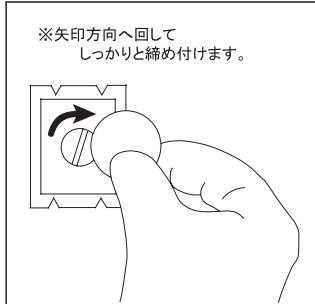
雲台のシュー固定レバーを最後まで起こして、クイックシューを外します。カメラ底面のネジ穴にクイックシューのカメラネジを合わせ、裏側からコイン等で上図矢印方向へ回し、しっかりと締め付けます。
