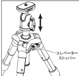
エレベータースtopバーを回して緩め手動で高さを調整します。必要な高さでエレベータースtopバーを締めて、固定して下さい。
