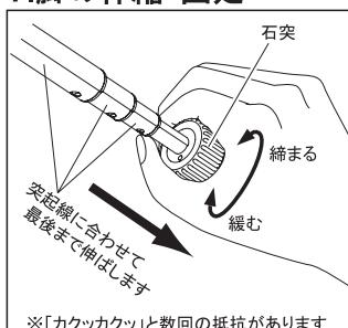
脚を伸ばすには、脚先端の石突を握って緩む方向に「カクッカクッ」と数回の抵抗が止まるまで回します。脚を最後まで引き伸ばし、石突を締まる方向にキツメに回して脚を固定します。脚を縮めるときは逆の手順を行います。
