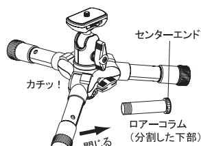
ローポジション(上図イラスト)にした脚をゆっくり閉じていくと、開脚調整ノブが自動的にカチッと左方向へスライドします。この位置がセミローポジションとなります。
