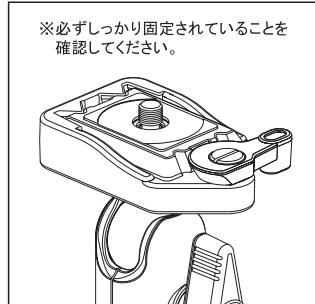
シュー固定レバーの操作は、カメラ落下防止のため必ずカメラを保持しながらおこなって下さい。またシュー固定レバーが最後まで押し込まれ、クイックシューが装着部からはみ出したりせず、動かさずに確実に固定されていることを確認して下さい。
