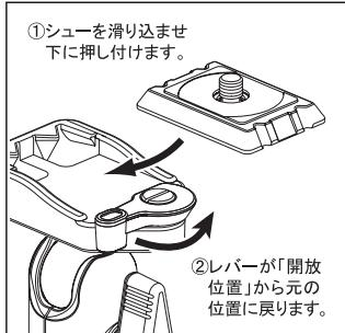
シュー固定レバーを「開放位置」にした状態で、クイックシューをレバー側から斜めに滑らせるようにして取付け、下に押し付けると半自動固定されます。さらに指でレバーを押し込み、確実に固定して下さい。外す際は逆の手順をおこなって下さい。
