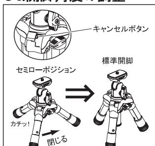
さらに脚を開じていくと、再び開脚調整ノブが自動的にカチッとスライドします。なお誤ってノブをスライドさせてしまった時は、キャンセルボタンを押すことによって元の位置に戻すことができます。
