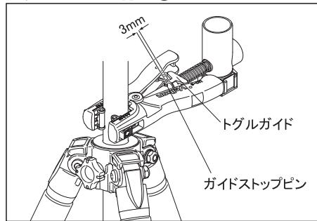
上図のように三脚のセンター棒を上げ(30mm以上)、洗濯バサミのようにしてUC-6を取り付けます。この時トグルガイドとガイドストップピンの間に約3mmの隙間が空くのが最適位置です。
