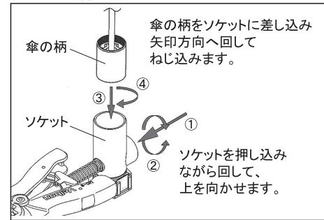
まずUC-6の本体をしっかりとおさえ、ソケットを押し込みながら回し、上を向かせます。次に傘の柄をソケットに差し込み、上矢印方向へ回してねじこみます。
