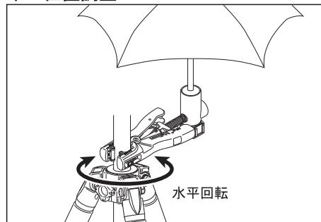
UC-6はセンターコラムの周りを自由に水平回転します。また傘を傾け、傘の縁から垂れる重を制御できます。さらに傘をサンシェードにしたり、付属傘裏側のレフ面を使って、ストロボ撮影時の発光部面積を大きくすることも可能です。
