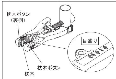
2つの枕木ボタンを指で押してスライドさせながら移動させ、取り付けるセンター棒に合わせます。枕木にはULTRA/Sherpa/Carmagneシリーズの各サイズに合うよう、目盛りが付いています。
