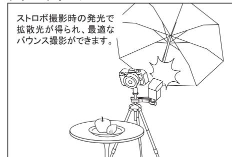
ストロボ撮影時の発光で拡散光が得られ、最適なパウンド撮影ができます。
