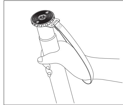
転倒事故防止・安定保持のため、必ず上図のようにリストバンドを手首に通してカメラを支えて下さい。
