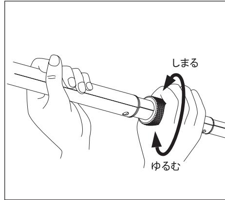
脚の長さを調整するには、二段目の調整用グリップを握り、矢印のゆるむ方向に回してからおこないます。調整し終わったら矢印のしまる方向へキツめに回し、脚を固定します。
