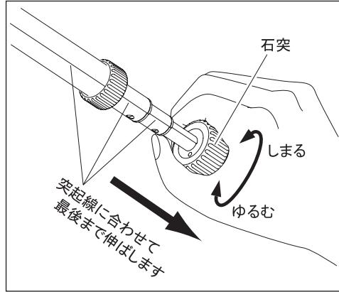
脚を伸ばすには、脚先端の石突を握り、ゆるむ方向に「カクッカクッ」と4回抵抗があるまで回します。脚を最後まで引き伸ばし、石突をしまる方向にキツめに回して脚を固定します。脚を縮めるときは逆の手順をおこなって下さい。
