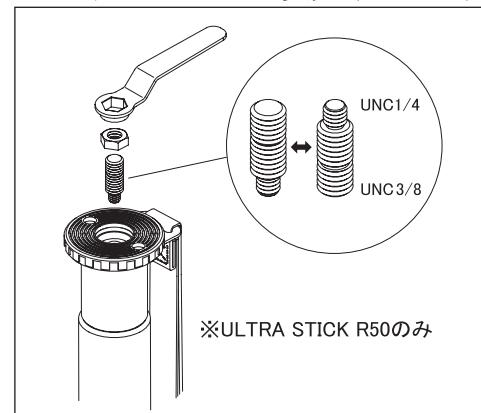
ULTRA STICK R50のカメラネジは、UNC1/4と3/8両方のサイズに対応可能です。通常UNC1/4(細ネジ)になっていますが、海外メーカー製の雲台を取り付ける場合は、UNC3/8(太ネジ)にサイズ変換する必要があります。その場合は付属の工具で台座の六角ナットを外し、カメラネジを逆向きにしてねじ込みます。その後、六角ナットを元通りしめこみます。
