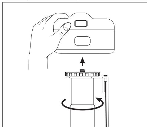
カメラのネジ穴にカメラネジを合わせ、一脚全体を上図矢印方向に回してしっかりと固定します。
