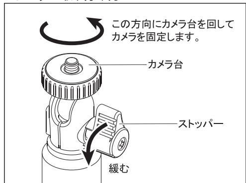
雲台のストッパーを上図矢印方向に緩め、カメラ底面の取付ネジ穴とカメラネジを確実に合わせてから、カメラ台を回してしっかりと締め付けます。
