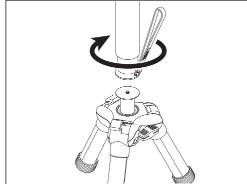
本製品は台座に取付ネジ穴があるので、三脚に取り付けて延長棒などとして使うことができます。上図の矢印方向に本製品全体を回すか、三脚の雲台に取り付ける場合はカメラネジでしっかりと固定して下さい。
