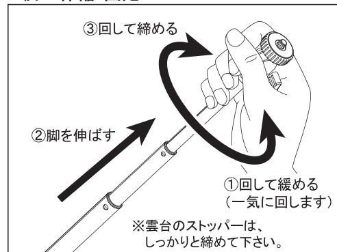
脚を伸ばすには、雲台のストッパーをしっかりと締めて固定し、その雲台ごと握ってゆるむ方向に「カクッカクッ」と5回の抵抗があるまで一気に回します。脚を最後まで引き伸ばしたら、今度は雲台ごと締まる方向にキツめに回して脚を固定します。脚を締めるときは逆の手順をおこなって下さい。
