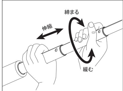
脚の長さを調整するには両手で脚関節を挟んでしっかりと握り、上図矢印の緩む方向に回してから伸縮させます。調整が終わったら上図矢印の締まる方向へキツめに回し、脚を固定します。
