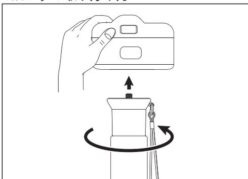
カメラ底面の取付ネジ穴に一脚のカメラネジを合わせ、一脚全体を矢印方向に回してしっかりと固定します。
