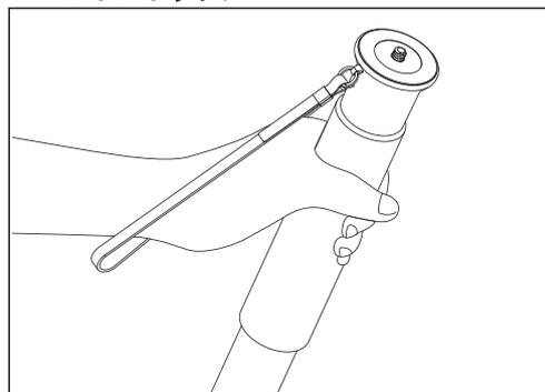
転倒事故防止・安定保持のため、必ず上図のようにハンドストラップを手首に通してカメラを支えて下さい。
