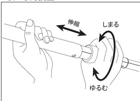
脚の長さを調整するには、2段目の調整用グリップを握り、矢印のゆるむ方向に回してからおこないます。調整が終わったら矢印のしめる方向へきつめに回し、脚を固定します。
