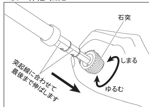
脚を伸ばすには、脚先端の石突を握りゆるむ方向に「カクカク」と段数の節目分の抵抗が止まるまで一気に回します。脚を最後まで引き伸ばしたら、今度は石突をしめる方向にきつめに回して脚を固定します。脚を縮めるときは、逆の手順をおこなして下さい。
