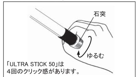
脚を伸ばすには脚先端の石突を握って、ゆるむ方向に一気に回します。この時「カクッカクッ」と3回(又は4回)のクリック感があります。
