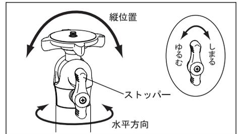
ストッパーをゆるめると、上図矢印の方向へカメラが自由に動きます。構図が決ったところでストッパーをしめて固定し、撮影してください。
