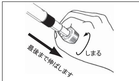
次に脚を最後まで引き伸ばし、再度石突をしめる方向にキツめに回して脚を固定します。脚を縮めるときは逆の手順を行ってください。
