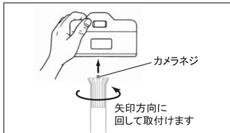
カメラのネジ穴にカメラネジを合わせ、一脚全体を上図矢印方向に回して固定します。
