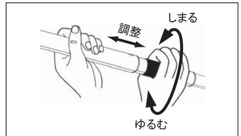
脚の長さを調整するには二段目の発泡ゴムグリップを握り、矢印のゆるむ方向に回してからおこないます。調整が終わったら矢印のしめる方向へキツめに回し脚を固定します。
