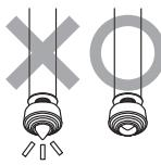
三脚には、推奨積載質量が設定されています。必ずその範囲内のカメラを使用して下さい。特に雲台が付いた三脚自重の2倍を超えるカメラを使用すると、安定性が極端に悪くなりますのでご注意下さい。三脚が転倒し死亡や大ケガにつながる恐れがあります。またカメラブレの原因にもなります。
