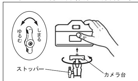
ストッパーを反時計方向に回してゆるめ、カメラのネジ穴と雲台のカメラネジを合わせ、カメラ台を上図矢印方向へ回して固定します。
