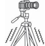
カメラを装着したまま脚の伸縮調整や雲台の操作をする際は、必ずカメラ本体を手で支えながらおこなってください。三脚やカメラが不意に動き、カメラを破損したり手を三脚にはさみケガをする恐れがあります。カメラやレンズの形状によってはバランスが取り難いこともありますので、十分に気をつけて下さい。
