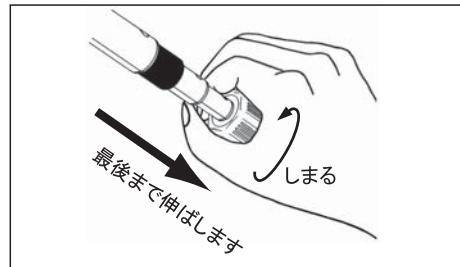
次に脚を最後まで引き伸ばし、再度石突をしまる方向にキツメに回して脚を固定します。脚を縮めるときは逆の手順を行ってください。
