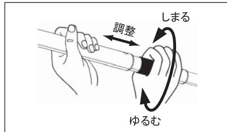
脚の長さを調整するには二段目の発泡ゴムグリップを握り、矢印のゆるむ方向に回してからおこないます。調整し終わったら矢印のしまる方向へキツメに回し脚を固定します。
