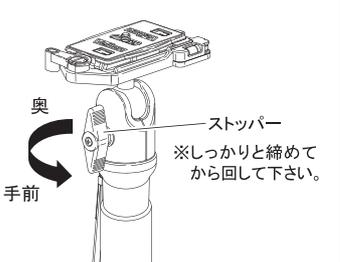
雲台を交換する場合は、ストッパーをしっかりと締め、雲台全体を反時計方向に回して下さい。他の雲台に交換可能です。
