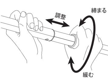
脚の長さを調整するには、二段目の調整用グリップを握り、緩む方向に回して伸縮調整します。調整後は締まる方向へきつめに回し、脚を固定します。
