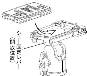
シュー固定レバーを開放位置にした状態で、クイックシューをレバー側から斜めに滑らせる様に取り付け、下に押し付けるとレバーが戻り半自動固定されます。後は手動でレバーを最後まで押し込んで下さい。
