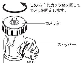
雲台のストッパーを上図矢印方向に緩め、カメラ底面の取付ネジ穴とカメラネジを確実に合わせてから、カメラ台を回してしっかりと締め付けます。
