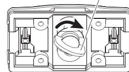
カメラ底面のネジ穴とクイックシューのカメラネジを確実に合わせ、クイックシュー裏面のカメラネジつまみを起こして回し、しっかりと確実に取り付けして下さい。
