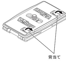
背当てをおこなすと、縦位置撮影時のレンズ重さによる「前倒れ」を防ぐことができます。カメラネジの位置を調整してカメラの背面にうまく合わせて下さい。
