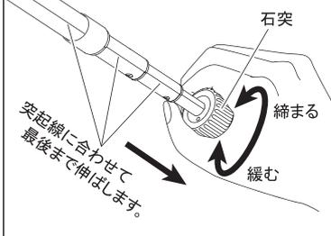
脚を伸ばすには、脚先端の石突を握り、緩む方向に「カクカク」と段数の節目分の抵抗が止まるまで一気に回します。脚を最後まで引き伸ばしたら、石突を締まる方向にきつめに回し固定します。脚を縮める際は、逆の手順をおこなって下さい。
