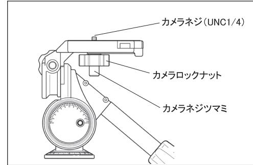
カメラ底面のネジ穴にカメラネジを合わせ、カメラネジツマミを回してしっかりと固定し、最後にカメラロックナットを回して締めします。
