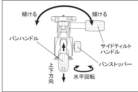
パンハンドルを回し緩めるとカメラの上下方向が変えられます。パンストッパーを緩めるとカメラを水平方向に回転させることができます。サイドティルトハンドルを緩めるとカメラの傾きが変えられます。フレームが決まった位置で各ハンドルやストッパーを確実に締め、シャッターをきります。
