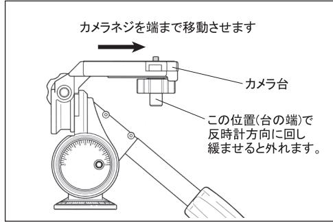
この雲台は、購入時にはUNC1/4カメラネジ(細ネジ)が装着されていますが、必要に応じて同梱のUNC3/8カメラネジ(太ネジ)に交換することができます。カメラネジはカメラ台の端まで移動し、反時計方向に回して最後まで緩ませると外すことができます。
