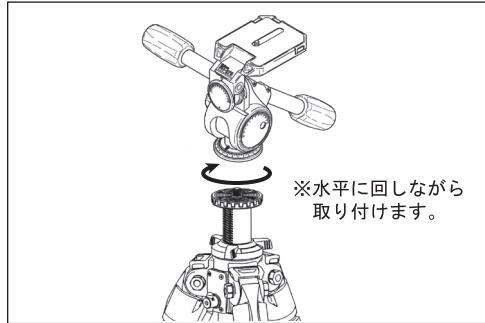
三脚への取り付けは、各ストッパーを完全に締め、取付ネジ穴を合わせて雲台全体を上図矢印方向に回し、しっかりと固定して下さい。
