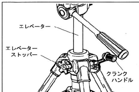
エレベーターストッパーを左に回しゆるめクランクハンドルをまわすとエレベーターの昇降が行えます。高さがきまったらエレベーターストッパーを右に回して固定します。
