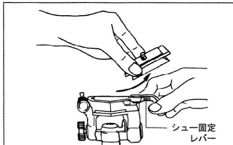
シュー固定レバーをFREEの方向にゆるめクイックシューを矢印方向にスライドさせながら外します。
