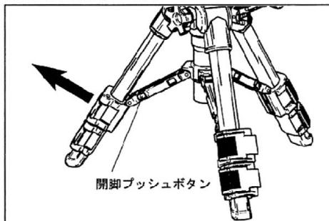
各々の脚は開脚プッシュボタンを左右から押しながら開くとステーが伸びて更に脚を開くことができます。開脚角度は標準とフル開脚の2段階です。標準開脚に戻す時はプッシュボタンを抑えずに脚を閉じます。
