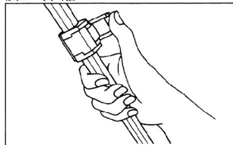
脚の長さを調整する時は右手の親指で脚固定レバーを起しロックを外し、上の段から順に伸ばしてください。脚の長さが決まったらレバーを押さえてロックします。縮めるときは逆に下の段から順にしまってください。
