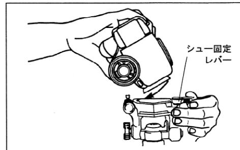
クイックシューをカメラに固定したら、シュー固定レバーをFREE方向にしてカメラを矢印のように斜め横から水平になるまですべり込ませます。さらにシュー固定レバーをLOCK方向に回して固定してください。(カメラを落とさないように注意して操作してください。)
