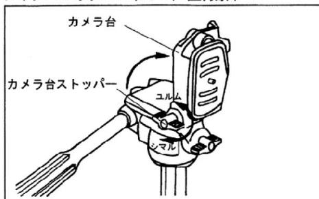
カメラ台ストッパーを左に回しカメラ台を右に起こすとカメラの縦位置撮影が行えます。撮影の際はカメラ台ストッパーを右に回ししっかり固定してください。
